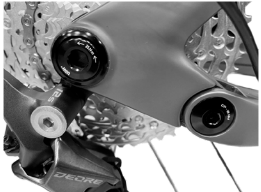
Chain Stay: ambos lados: esquerdo e direito #3 Pivot Inferior Traseiro Chain Stay
