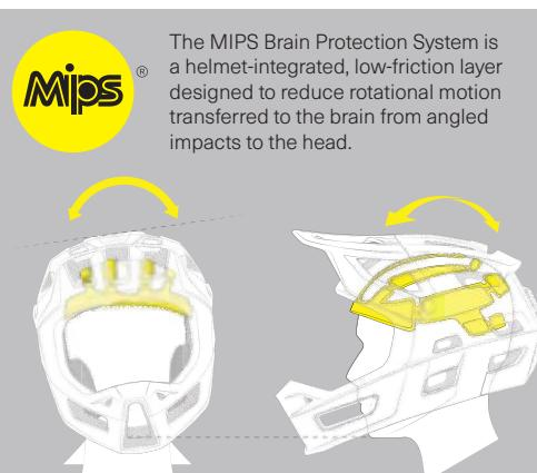
Das MIPS Brain Protection System ist ein im Helm integriertes System, welches über Einlagen mit geringer Reibungsoberfläche auftretende Rotationskräfte aufs Gehirn reduziert.
