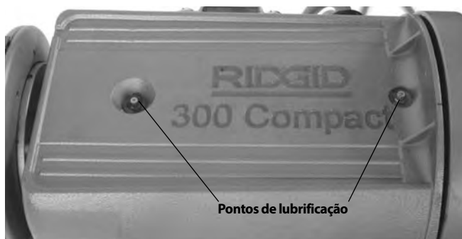
Figura 29 – Pontos de Lubrificação
