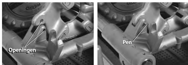
Afbeelding 26 – Linkse snijkop op zijn plaats houden
