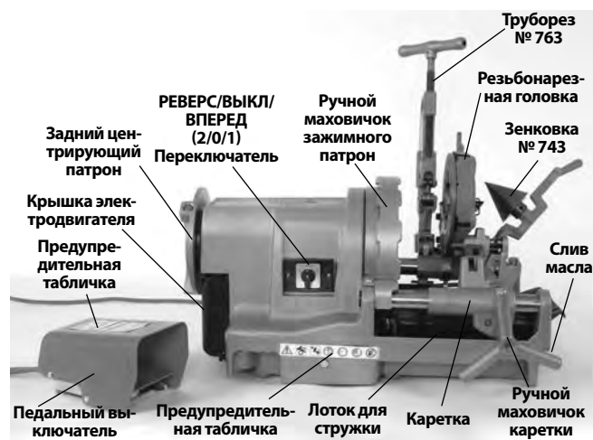
Рис. 2 – Резьбонарезной станок модели 1233
