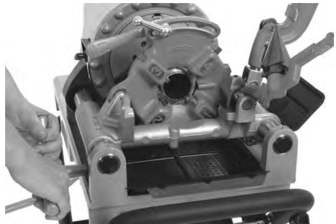
Figura 24 – Filetare țevi (811-este reprezentat un cap-filieră cu deschidere rapidă)
