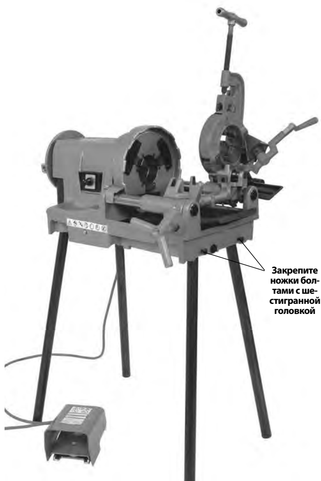
Рис. 4 – Установка резьбонарезного станка на трубные стойки
