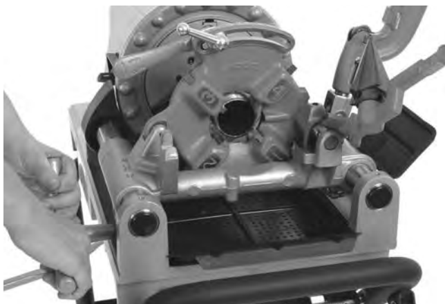
Figura 24 – Tubo de Roscagem (811- Uma Cabeça de Roscar de Abertura Rápida Mostrada)
