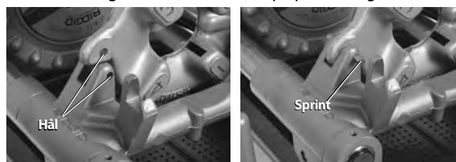
Figur 26 – Hålla fast vänstergängat gänghuvud
