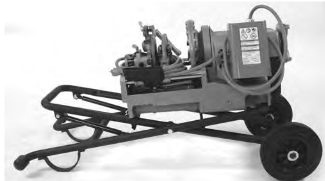
Figur 28 – Maskin förberedd för transport
