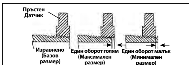
Фигура 27 – Проверка на размер на резба
