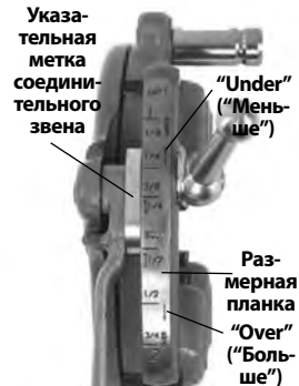
Рис. 9 – Настройка размера резьбы
