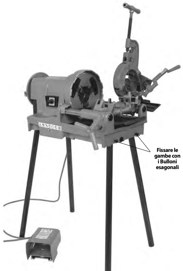
Figura 4 – Filettrice montata sulle gambe a tubo
