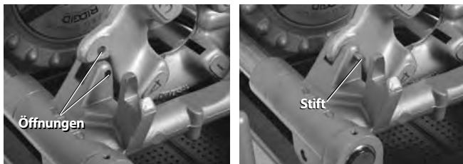
Abbildung 26 – Halten des Linksgewindeschneidkopfs
