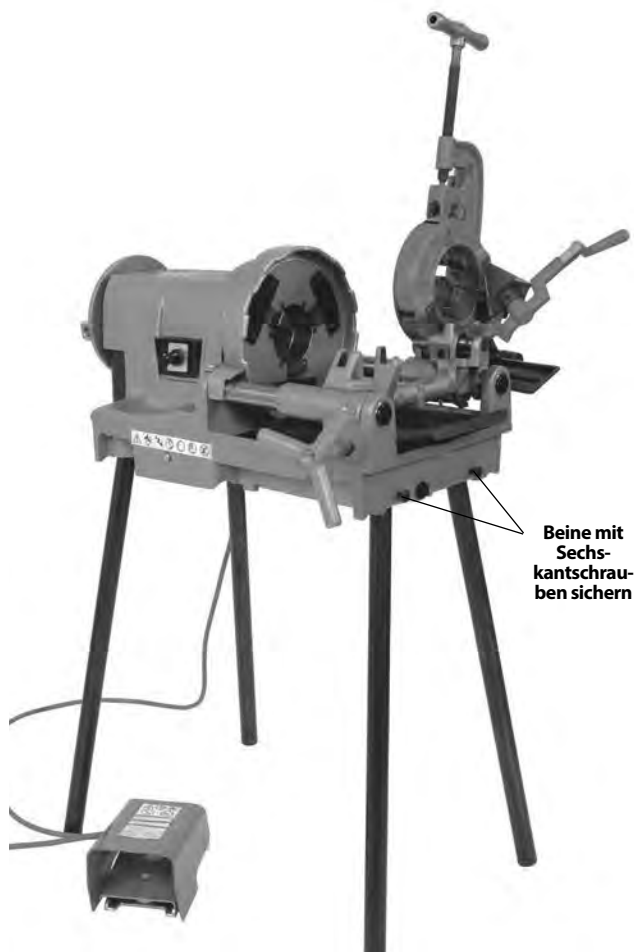
Abbildung 4 – Gewindeschneidmaschine auf Rohrstücken montiert
