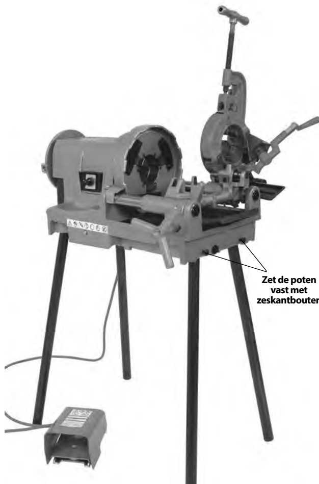
Afbeelding 4 – Schroefdraadsnijmachine gemonteerd op buispoten
