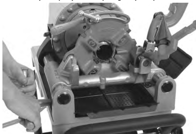
Rys. 24 – Gwintowanie rury (pokazano szybkoobrotową głowicę gwinciarzką 811-A)
