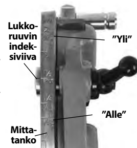
Kuva 13 – Kierteen koon säätäminen
