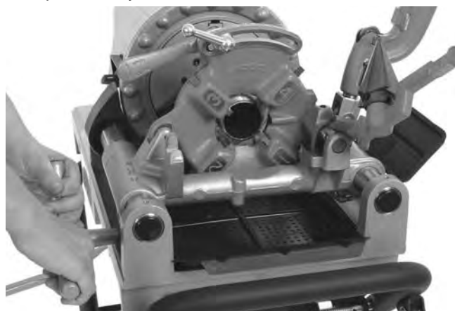
Slika 24 – Narezivanje navoja na cev (prikazana je brzootvarajuća narezna glava 811-A)
