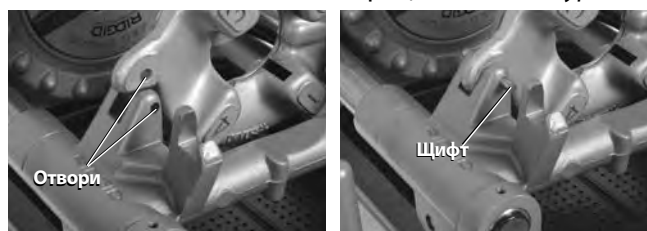
Фигура 26 – Закрепване на място на глава за матрици за лява резба
