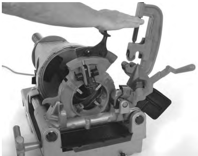
Afbeelding 19 – De wijkende snijkop sluiten
