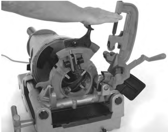
Abbildung 19 – Schließen des versenkten Schneidkopfs
