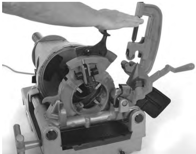
Figura 19 – Fechar a Cabeça de Roscar de Retorno
