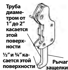
Рис. 14 – Регулировка положения защелки
