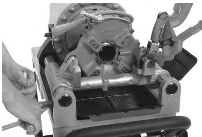
Kuva 24 – Putken kierteitys (kuvassa pika-aukeava kierrepää 811-A)
