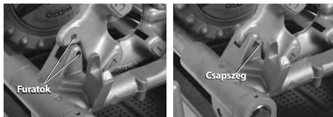
26. Ábra – A balmenetes menetvágófej rögzítése a helyén
