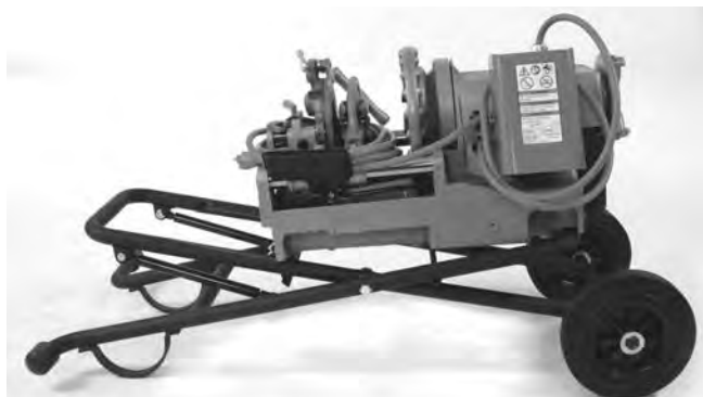
Kuva 28 – Kuljetusta varten valmisteltu kone
