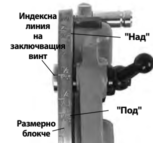
Фигура 13 – Регулиране на размера на резбата
