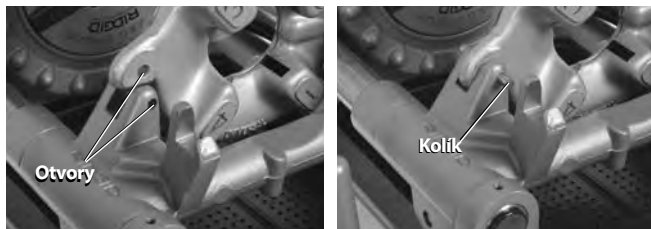
Obrázek 26 – Zajištění levotočivé závitorezné hlavy na místě
