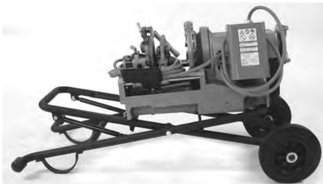
Рис. 28 – Станок, подготовленный к транспортировке
