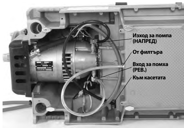
Фигура 25В – Връзка на маслената помпа за дясна резба (Превключвател в позиция FWD)
