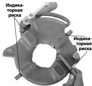
Рис. 8 – Вставка резьбонарезных гребенок
