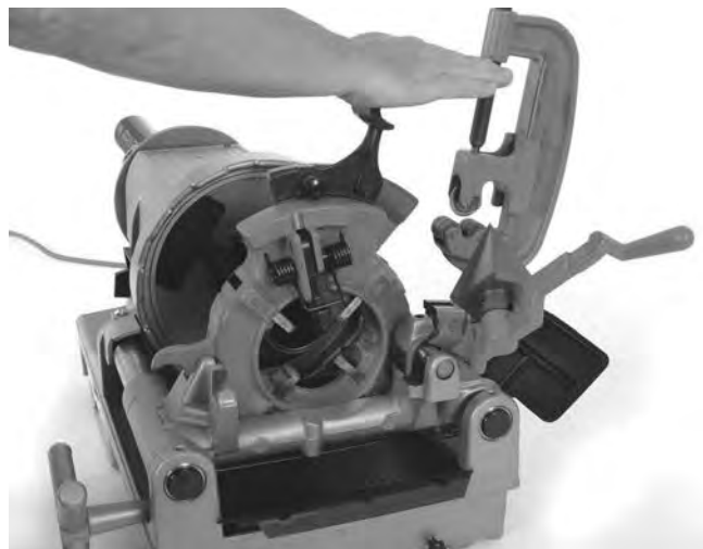
Рис. 19 – Закрывание отводимой резьбонарезной головки
