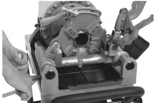
Εικόνα 24 – Ελικοτόμηση σωλήνα (Εικονίζεται η φιλιέρα γρήγορου ανοίγματος 811-A)
