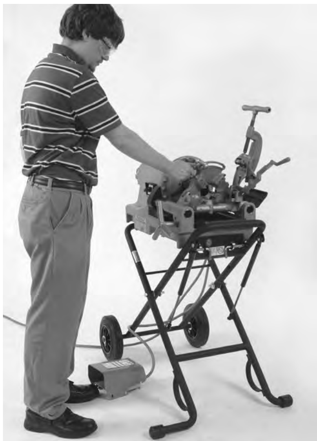
21. Ábra – Üzemeltetési testhelyzet
