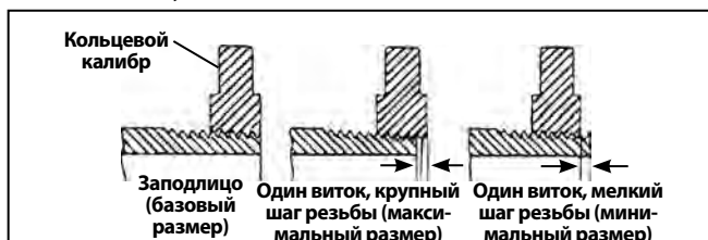
Рис. 27 – Проверка размера резьбы
