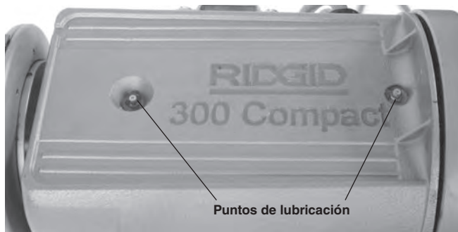
Figura 29 – Puntos de lubricación
