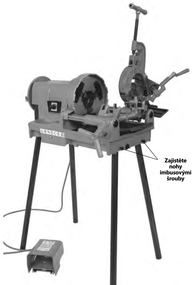
Obrázek 4 – Závitorezný nástroj namontovaný na trubkových nohách
