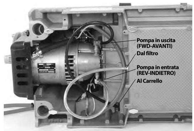
Figura 25B – Connessioni della pompa dell'olio per la filettatura a destra (Interruttore in FWD-AVANTI)
