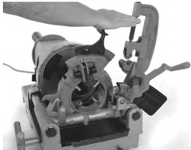
Obrázek 19 – Zavření ustupující závitorezné hlavy
