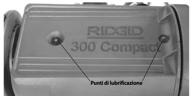
Figura 29 – Punti di lubrificazione
