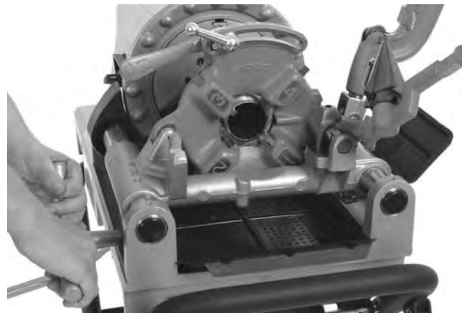
Figur 24 – Gjenging av rør (811-A Hurtigåpnende gjengebakkeholder)
