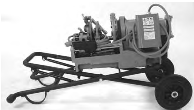
Figura 28 – Máquina Preparada para Transporte
