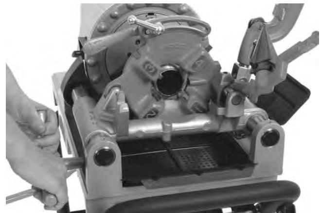
Obrázok 24 – Rezanie závitú na rúre (znázornená je rýchlozáverná závitová hlava 811-A)
