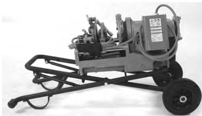
Rys. 28 – Maszyna przygotowana do transportu
