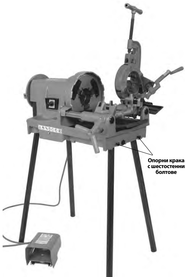
Фигура 4 - Машината за резбоване, монтирана на тръбни крака
