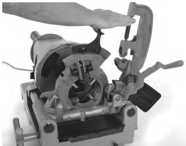
Figur 19 – Stänga det infällda gänghuvudet
