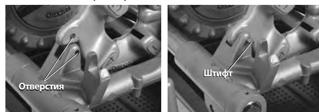
Рис. 26 – Фиксация левой резьбонарезной головки на месте
