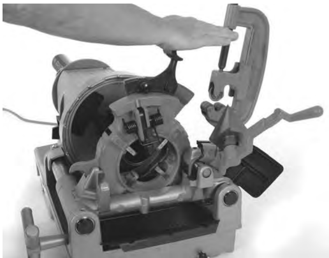
Rys. 19 – Zamykanie wycofywanej głowicy gwinciarzkiej
