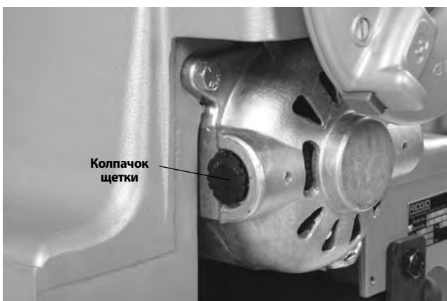
Рис. 32 – Снятие крышки электродвигателя/замена щеток
