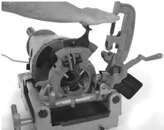
Figur 19 – Lukking av den skrånede gjengebakkeholderen
