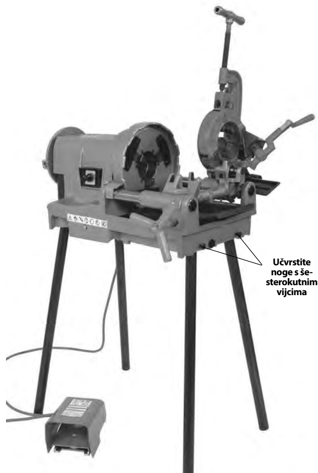
Slika 4 – Uređaj za narezivanje montiran na noge od cijevi
