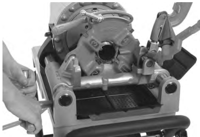
Slika 24 – Narezivanje cijevi (811-A prikazana brzo otvarajuća narezna glava)
