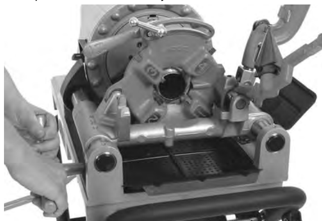
Obrázek 24 – Řezání závitů trubky (je zobrazena rychle otevírací závitorezná hlava 811-A)
