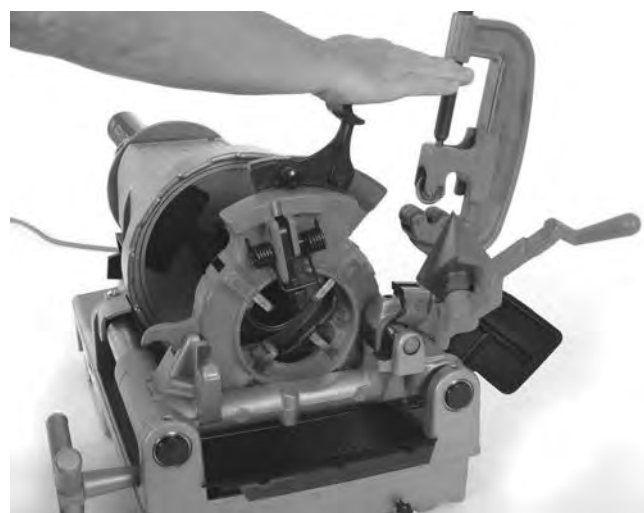
Slika 19 – Zatvaranje narezne glave sa uzmicanjem noževa
