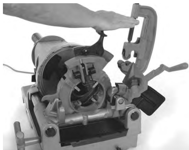
Obrázok 19 – Zatvorenie ustupujúcej závitovej hlavy
