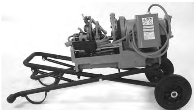
28. Ábra – A gép szállításhoz előkészítve
