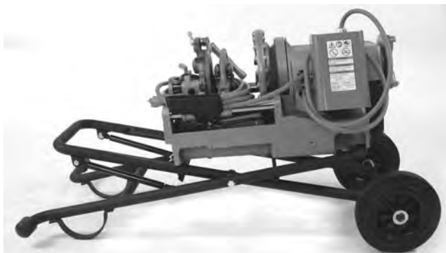
Obrázok 28 – Stroj pripravený na prepravu
