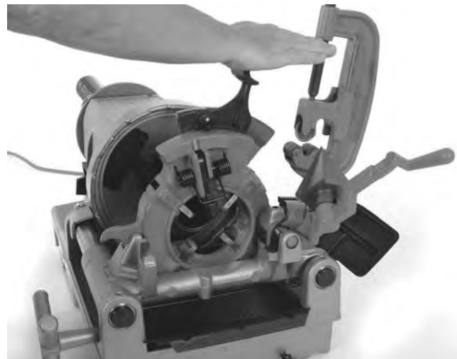
19. Ábra – A visszahúzó önynyitó menetvágófej bezárása
