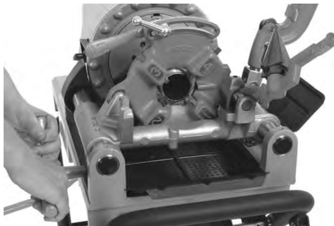
24. Ábra – Menetvágó cső (az ábrán a 811-A gyorsnyitósú menetvágófej látható)
