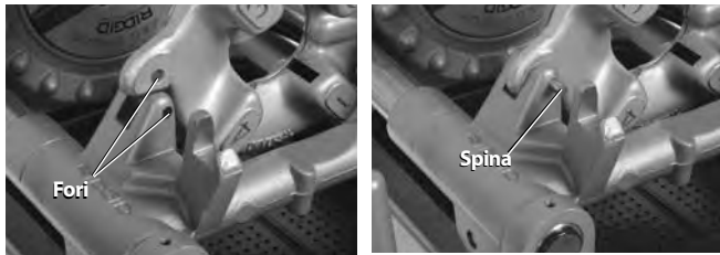
Figura 26 – Trattenimento in posizione della Testa portapettini sinistra
