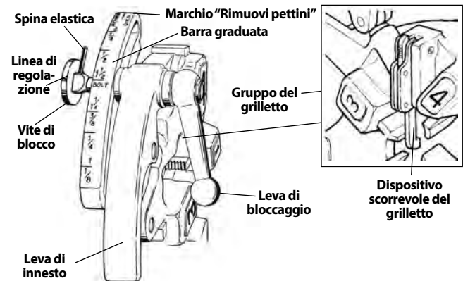
Figura 10 - Testa portapettini ad apertura automatica universale
