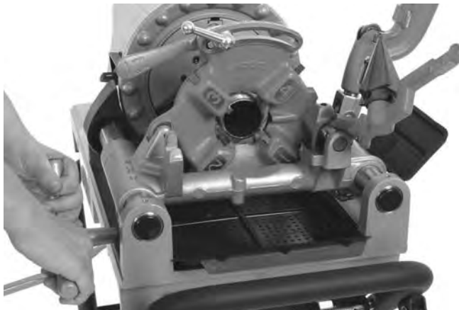
Slika 24 – Rezanje navojev cevi (811-Prikaz hitrega odpiranja navojnega rezalnika)
