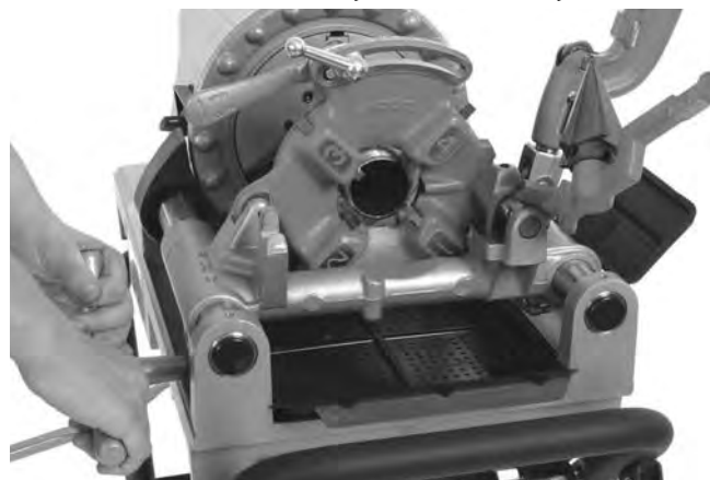
Afbeelding 24 – Pijpdraad snijden (Afgebeeld: 811-A snel-openende snijkop)
