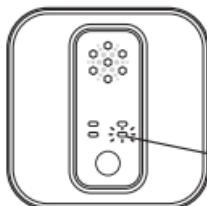
Una alarma suena continuamente durante 4 minutos “Beep Beep Danger – gas leak explosion risk – evacuate, then call 911” seguido de “Bip, bip. Peligro. Riesgo de explosión por fuga de gas. Evacuar, luego llamar al 911” y, luego, se repite cada 1 minuto.
