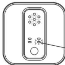
An alarm sounds “Beep Beep Danger – gas leak explosion risk – evacuate, then call 911” followed by “Bip Bip Peligro – riesgo de explosión por fuga de gas – evacuar, luego llamar al 911.”
