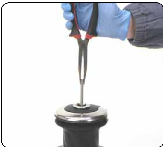
1. Pull out the disconnect rod n°30
