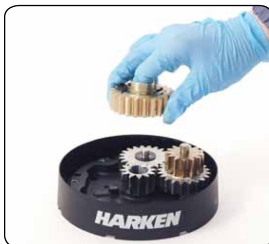
11. Remove the gear n°7
