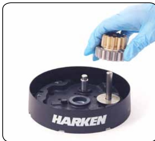
15. Remove the gear n°10
