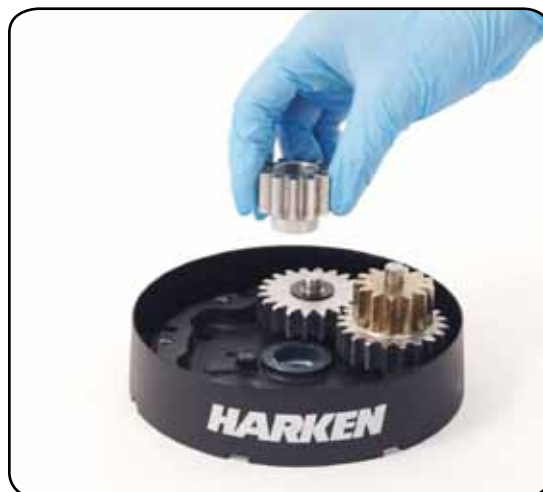
13. Remove the gear n°3
