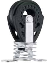
Mit dem Augbügel als Schablone die Bohrungen mit Körner markieren. Block abnehmen und bohren mit 4.2mm Einsatz. Deckseitig mit kleinem Messer abfasen damit sich Dichtmasse ansammeln kann. Block anschlagen mit empfohlenen durchgehenden rostfreien Bolzen, selbstsichernden Muttern und Scheiben.
