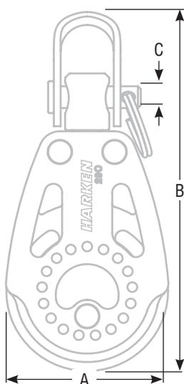
**Wangen aus Glasfaser-verstärktem Nylon; Kugellager mit runder Lagerschale für höhere Lasten**
