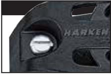
Verwenden Sie den Block als Schablone und markieren die Bohrungen mit einem Körner. Block abnehmen und bohren mit 4.2mm Einsatz. Deckseitig mit kleinem Messer abfasen damit sich Dichtmasse ansammeln kann. Block anschlagen mit empfohlenen durchgehenden rostfreien Bolzen, selbstsichernden Muttern und Scheiben.
