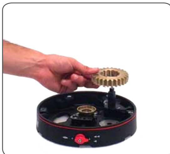
13. Remove the ratchet gear n°7
