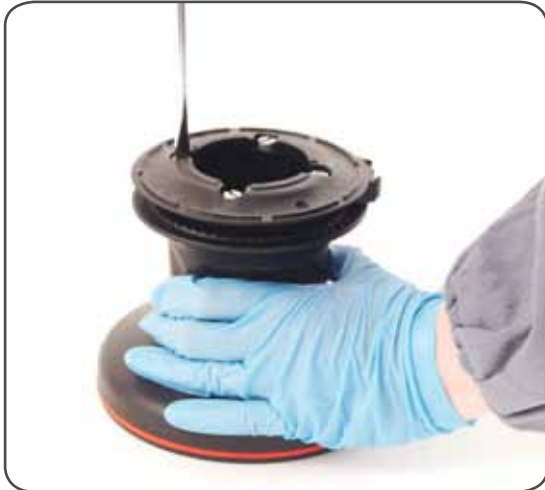
I. Unscrew the 4 screws n°43 ( \approx 4\text{Nm}/35\text{ in-lb} )
