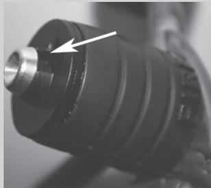
En la posición "desbloqueada", el basculante se caerá cuando se levante la bicicleta.
