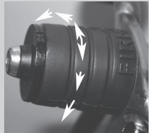
Para cambiar entre las posiciones "bloqueado" y "desbloqueado", gire el bloque de suspensión de una posición a otra.
