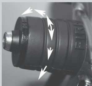
Pour alterner entre les positions « bloquée » et « débloquée », tournez le bloc de suspension sur l'une des deux positions.
