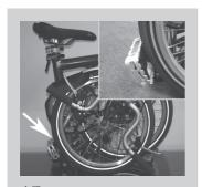
**步骤5** 旋转曲柄,使右侧踏板触及 前轮
