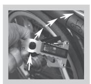
步骤6 向下按压踏板的锁板,以便露出 踏板的外部零件,对踏板进行 折叠。
