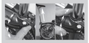
**步骤3** 解开快拆柄,将座管及座垫拉起直至尽头,或拉到某一适合您的高度。拧紧快拆柄,快拆柄应包裹座管外部, 在闭合状态下可触及车架。座垫应指向正前方。
