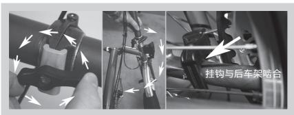
拧松车体上的铰链夹钳(约4圈)。握紧车把手支撑,同时将座垫向后推,采取"搅动"姿势移动座垫,直至其停留在后轮旁边。确保挂钩与后车架上的金属管啮合。
