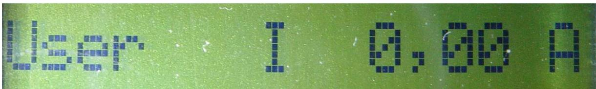
Este modo de exibição mostra quantos ampere estão a ser utilizados pelo aparelho eléctrico através da saída de carga.
