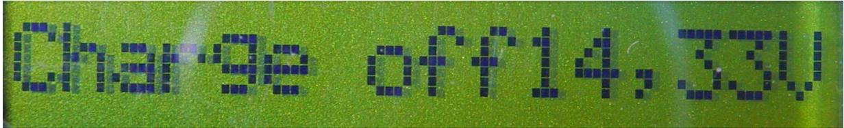
No display exibido acima, „charge off“, pode ajustar a tensão máxima da bateria com os botões „+“ e „-“. Considere sempre as recomendações do fabricante das baterias. A tensão máxima depende da voltagem do sistema (12/24V) e do tipo de baterias utilizadas (chumbo-ácido, gel ou AGM).
