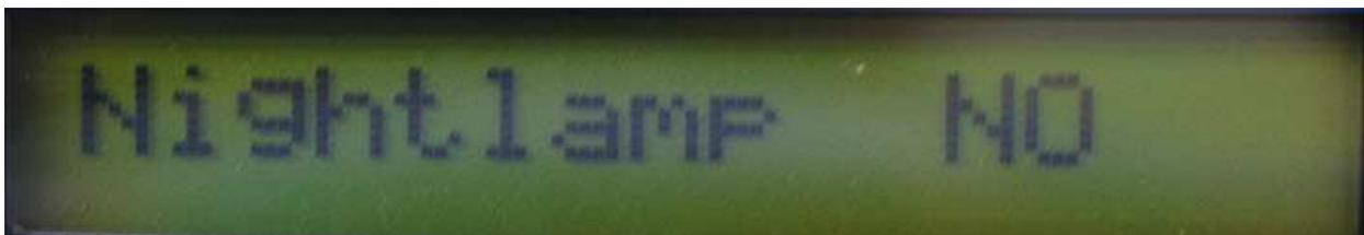
Atenção! Este parâmetro só funciona com painéis solares conectados. O controlador de carga reconhece, através dos painéis solares, se é dia ou noite, accionando ou desligando a luz de presença.
