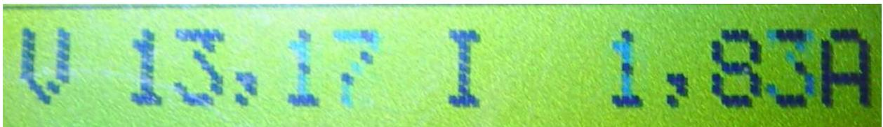
Pode consultar no display a tensão e corrente de carga da bateria. É apresentada a corrente total (solar e eólica conjunta).
