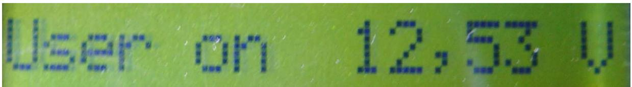
„User on“ define a tensão com que o aparelho eléctrico será de novo ligado. Como a tensão da bateria aumenta ao desligar o aparelho eléctrico, isto irá ligar e desligar a saída de carga se este valor não fôr suficientemente alto. Para a tensão de carga não ser detectada demasiado rápido, poderá ligar um aparelho eléctrico. Isto evita que o travão seja activado demasiado cedo.
