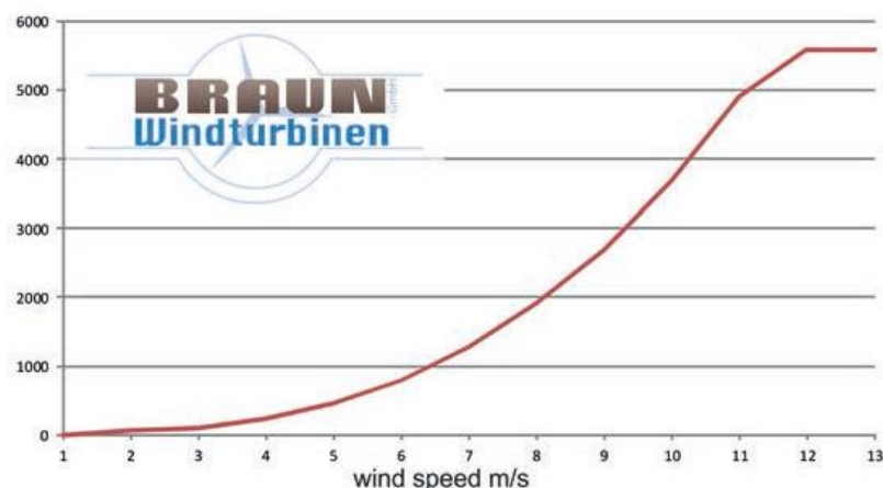
Turbinenkennlinie ANTARIS 4.5 kW
