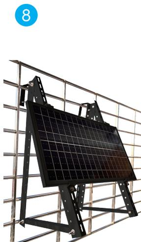
**Schritt 7** Befestigen Sie nun auf beiden Seiten die Haken (5) an der Halterung mit drei der kurzen Schrauben (6). Sollte eine der drei Schrauben die Anbringung an einem Geländer bzw. Balkon behindern, sind auch zwei Schrauben für eine sichere Anbringung der Haken an die Halterung ausreichend.
