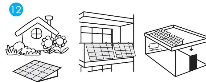
**Schritt 12** Die multifunktionale Halterung kann durch Ihre Konstruktion auch auf dem Boden oder einem (Flach-) Dach aufgestellt und befestigt werden. Mit den mitgelieferten Schrauben (3) können Sie die Halterung (1) z.B. an vorhandenen Befestigungsmöglichkeiten auf Dächern oder am Boden befestigen.
