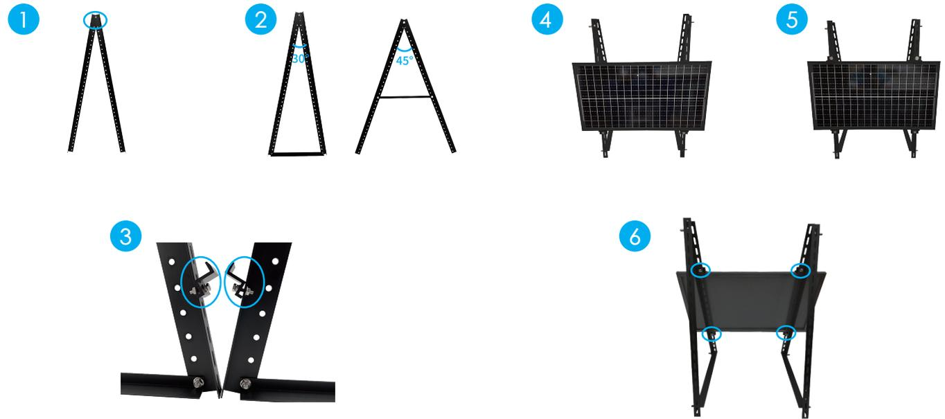
**Schritt 1** Schrauben Sie die zwei langen Halterungen (1) zusammen. Nehmen Sie dafür die Sechskantschrauben (1-3) und den beigelegten Maulschlüssel (8).
