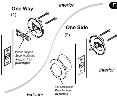
INSTALLATION TEMPLATE PLANTILLA DE INSTALACIÓN MODÈLE D'INSTALLATION
