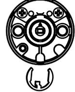
PARA CAMBIAR LA COMBINACIÓN DEL CILINDRO: EL CLIP DEBE SER REMOVIDO, PARA DESPRENDER DEL CENTRO, OPRIMIR AMBAS PUNTAS AL MISMO TIEMPO.
