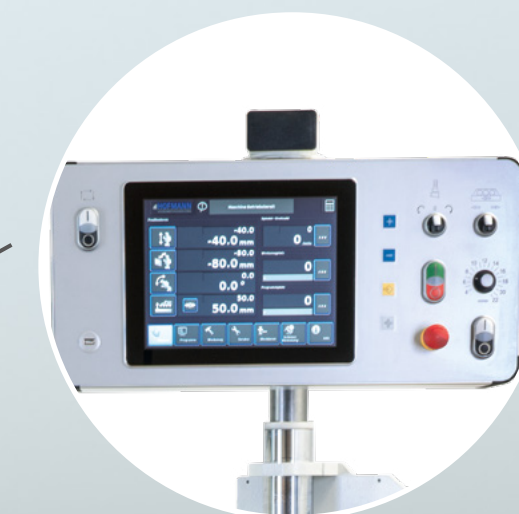
Großzügiges, modernes Bedienpult mit 12,1" Touch Monitor
