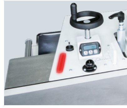
Sicherheitslichtleiste am Fräsanschlag
