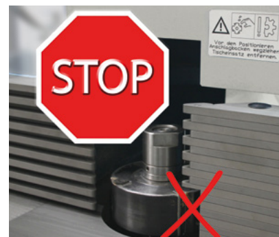
Guardian (die Klemmung der Anschlagbacken wird überwacht)
