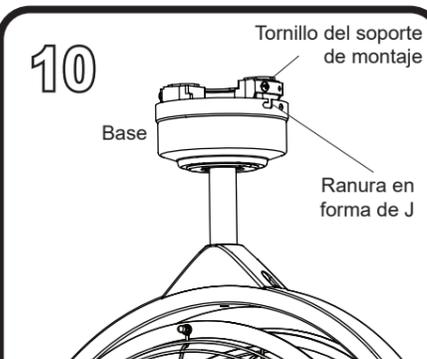
Levante la base y asegúrese de que los dos tornillos del soporte de montaje se encuentren alineados con las ranuras con forma de J de la base. Luego, gire la base en dirección de las manecillas del reloj hasta que los tornillos del soporte de montaje calcen por completo en las ranuras con forma de J.
