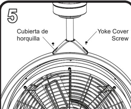
Retire los dos tornillos de la cubierta de la horquilla de la parte superior del ventilador. Utilice los dos tornillos de la cubierta de la horquilla para fijar la cubierta de la horquilla a la parte superior del conjunto del ventilador. A continuación, baje la cubierta de la horquilla para que descansa sobre el conjunto del ventilador.
