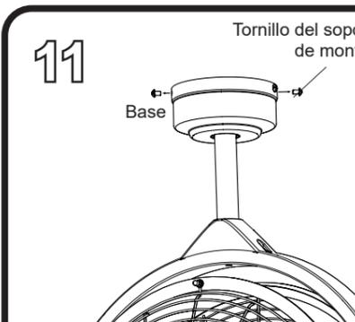
Instale los dos tornillos del soporte de montaje que extrajo anteriormente en los orificios redondos. Apriete con firmeza todos los tornillos del soporte de montaje.
