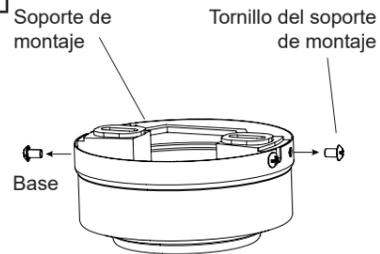
Afije los cuatro tornillos del soporte de montaje y retire completamente los dos tornillos de los orificios redondos de la base. Guárdelos para utilizarlos posteriormente. Retire la base del soporte de montaje.
