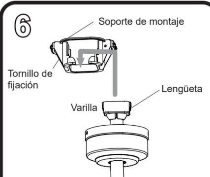
Instale la varilla en la abertura del soporte de montaje. Las lengüetas de la varilla deben mirar hacia los lados del soporte de montaje para encajar en las ranuras del interior del soporte de montaje. Vuelva a apretar los dos tornillos de fijación para asegurar.
