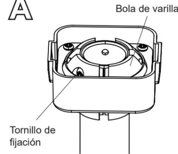
Incline la bola de la varilla en el soporte cuadrado para acceder al tornillo de fijación y retirarlo con un destornillador Phillips.
