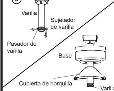
Seleccione una de las dos varillas. Si necesita una varilla más larga, consulte la página 2. A continuación, retire el sujetador y el pasador de la varilla. Introduzca la varilla a través de la base y la cubierta de la horquilla.
