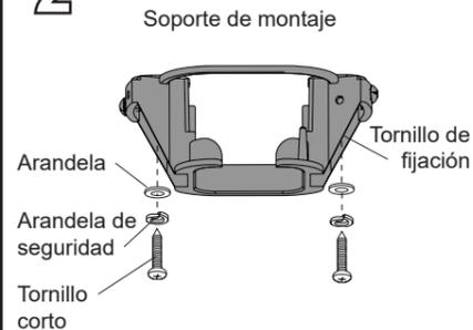
Utilice 2 tornillos cortos junto con una arandela y una arandela de seguridad para fijar el soporte de montaje a las vigas del techo. Luego, afloje, pero no retire, los dos tornillos de fijación en cada lado del soporte de montaje.
