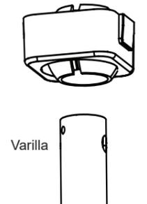
Quite la varilla y cámbiela por la varilla adicional. Deslice la varilla adicional en la bola de la varilla. Vuelva a colocar el pasador y el tornillo de fijación como se indica en los pasos anteriores.
