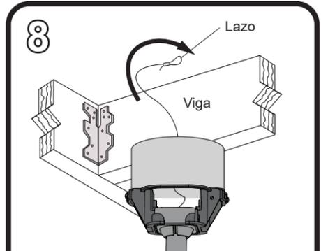
Pase el lazo del cable trenzado, preensamblado en la varilla, por el techo y alrededor de la viga del techo. **Importante:** el cable trenzado debe formar un círculo completo alrededor del soporte. **Nota:** puede ser necesario acceder a la viga desde el ático.
