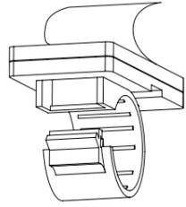
Use sujetadores para cable para asegurar el cable de alimentación del ventilador al techo en una ruta hacia el tomacorriente. Despegue el refuerzo de la cinta adhesiva de doble faz preensamblada en la parte posterior de cada sujetador para cable.
