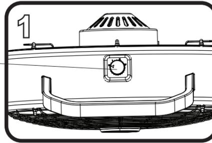
2. Utilice las perillas de inclinación de los costados del ventilador para ajustar el flujo de aire hacia arriba o hacia abajo. Afloje las perillas de inclinación girándolas en dirección contraria a las manecillas del reloj, ajuste el ventilador y vuelva a apretar las perillas de inclinación.
