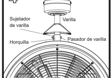
Deslice la varilla en la horquilla situada en la parte superior del ventilador y gire en dirección de las manecillas del reloj. Alinee los orificios y, a continuación, vuelva a instalar el pasador y el sujetador de la varilla para fijarlos.
