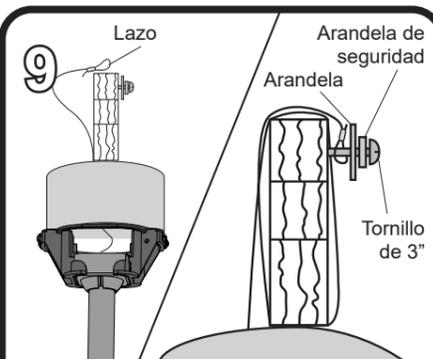
Instale el tornillo de 7,62 cm, la arandela metálica y la arandela de seguridad parcialmente en el costado del soporte instalado en el techo. Luego, levante el cable trenzado por sobre el soporte de techo y coloque el bucle abierto del cable trenzado alrededor del tornillo de soporte secundario. Apriete el tornillo de 7,62 cm.
