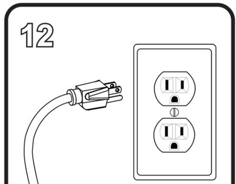
Enchufe el cable de alimentación en un tomacorriente de 120 V con puesta a tierra.
