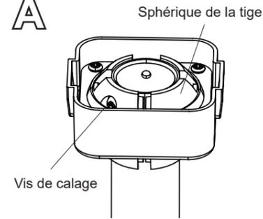
Inclinez la boule de la tige située dans le support carré pour accéder à la vis de calage et la retirer à l'aide d'un tournevis cruciforme.
