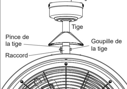
Glissez la tige dans le raccord situé sur le dessus du ventilateur et tournez-la dans le sens des aiguilles d'une montre. Alignez les trous, puis réinstallez la goupille et la pince de la tige pour fixer le tout.
