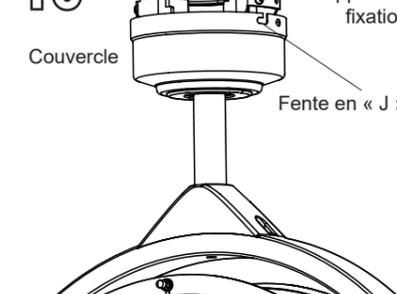
Soulevez le couvercle en vous assurant que les deux vis du support de fixation sont alignées sur les fentes en « J » du couvercle. Tournez ensuite le couvercle dans le sens des aiguilles d'une montre jusqu'à ce que les vis du support de fixation soient complètement engagées dans les fentes en « J ».
