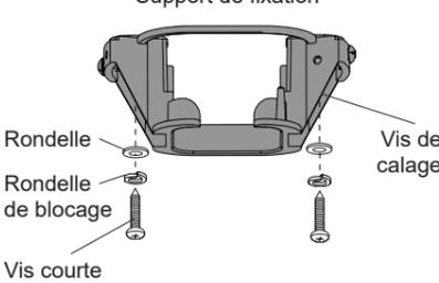
Utilisez 2 vis courtes avec une rondelle et une rondelle de blocage pour fixer le support de fixation aux solives du plafond. Ensuite, desserrez les deux vis de calage de chaque côté du support de fixation sans toutefois les retirer.
