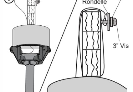
Insérez partiellement la vis de 3 po, la rondelle en métal et la rondelle de blocage dans le côté de l'entretoise fixée au plafond. Faites ensuite passer le câble tressé par-dessus l'entretoise du plafond et placez la boucle ouverte du câble tressé autour de la vis de soutien secondaire. Serrez la vis de 3 po.
