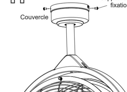
Installez les deux vis du support de fixation retirées précédemment dans les trous ronds. Serrez fermement toutes les vis du support de fixation.
