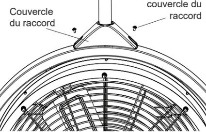
Retirez les deux vis du couvercle du raccord situé sur le dessus du ventilateur. Utilisez les deux vis du couvercle du raccord pour le fixer sur le dessus de l'ensemble du ventilateur. Abaissez ensuite le couvercle du raccord de façon à ce qu'il repose sur le dessus de l'ensemble du ventilateur.
