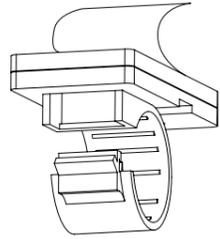
Utilisez des brides de cordon pour fixer le cordon d'alimentation du ventilateur au plafond de façon à ce qu'il puisse être acheminé à la prise de courant. Retirez la pellicule protectrice du ruban adhésif double face préfixé à l'arrière de chaque bride de cordon.
