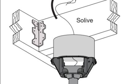
Faites passer la boucle du câble tressé, lequel est préassemblé à la tige, à travers le plafond et autour d'une solive de plafond. Important : Le câble tressé doit effectuer un tour complet autour de l'entretoise. Remarque : Il peut être nécessaire d'accéder à la solive depuis le grenier.
