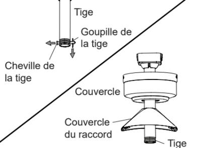
Sélectionnez l'une des deux tiges. Si une tige plus longue est nécessaire, consultez la page 2. Ensuite, retirez la pince et la goupille de la tige. Insérez la tige dans le couvercle, puis dans le couvercle du raccord.
