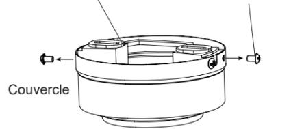
Desserrez les quatre vis de support de fixation et retirez complètement les deux vis des trous ronds du couvercle. Mettez les vis de côté. Retirez le couvercle du support de fixation.
