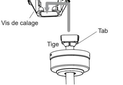
Insérez la tige dans l'ouverture du support de fixation. Les languettes de la tige doivent faire face aux côtés du support de fixation afin de s'insérer dans les fentes situées à l'intérieur du support de fixation. Resserrez les deux vis de calage pour fixer le tout.
