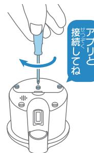
プラスドライバーでネジを固く締めます。本体から「アプリと接続してね」の音声が流れたら、ステータスランプの赤と緑が点滅するのを確認します。
