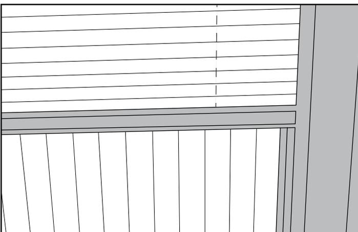
**Schritt 5:** Falls das Plissee nicht gleichmäßig schließt und öffnet, müssen Sie die Spannung der einzelnen Schnüre anpassen. Danach können Sie alle Schnüre mit einem doppelten Knoten versehen und versehen und die überschüssige Schnur abschneiden.
