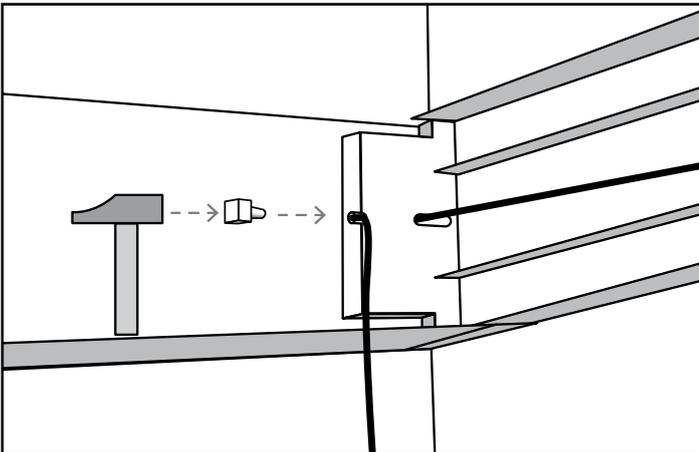
**Schritt 3:** Spannen Sie nun die Schnüre in den 4 Ecken. Ziehen Sie hierzu die jeweilige Schnur stramm und schlagen anschließend die Sperre mit einem Hammer in die Löcher. Bitte achten Sie darauf, dass Sie beide Seiten gleich stark spannen damit das Plissee gerade hängt.
