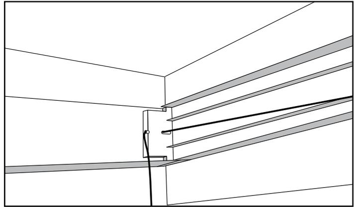
**Schritt 2:** Legen Sie die Längsprofile auf die Ecken der Breitenprofile und kleben Sie diese fest (Profile können bei Bedarf auch zusätzlich verschraubt werden).
