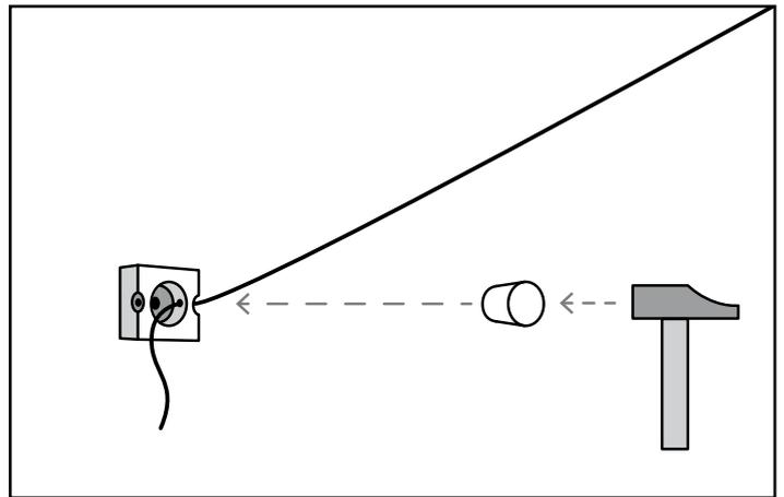
**Stap 4:** Schroef het middelste blokje/de middelste blokjes vast. Wikkel de middelste koorden los, rijg deze door het blokje en sla ze vast middels het borgblokje. Zorg er voor dat er voldoende spanning op deze koorden staat.
