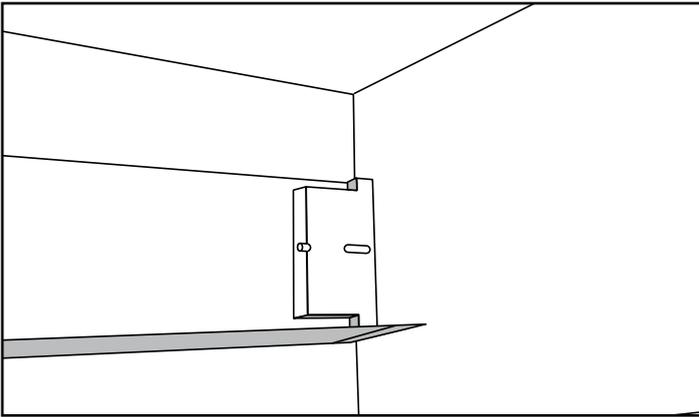
**Schritt 1:** Prüfen Sie, ob sich die Kunststoff-Endkappen in der Ecke befinden und kleben Sie die beiden kurzen Profile zwischen die jeweiligen Dachsparren.
