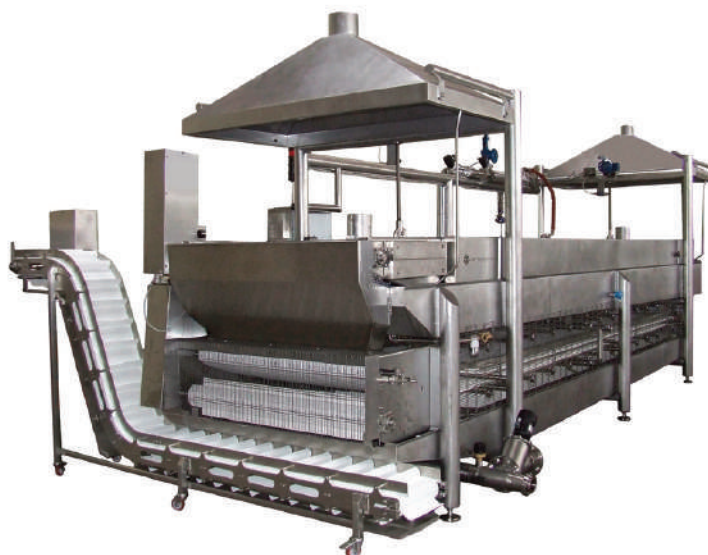
Linea di cottura e formatura cannelloni e sfoglia per lasagne.
