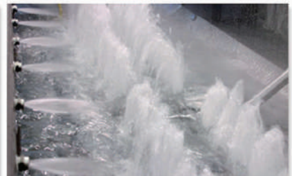
Turbolenza nella vasca di cottura Turbulence in the cooking tank
