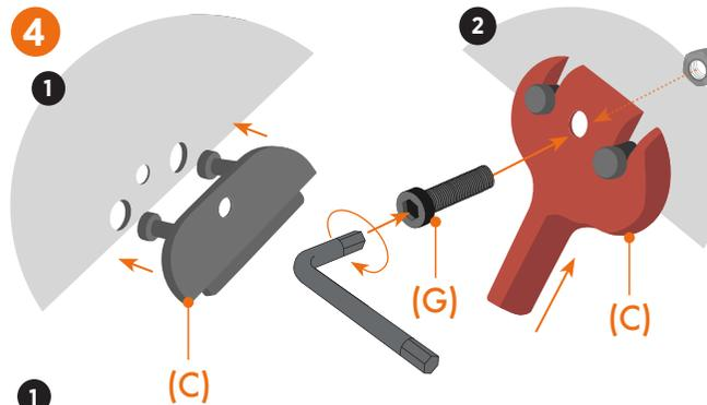
1 Munissez-vous des deux parties de la pièce socle (C), introduisez et clipsez entièrement les tenons de la pièce dans les trous prévus à cet effet dans la partie inférieure du corps de la girouette.
