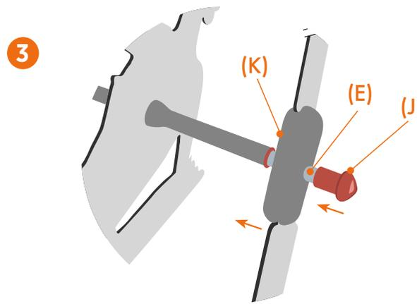
Coulez les pièces de jonction (K) par l'orifice de part et d'autre de l'axe (E) et placez les bouchons (J). Laissez un jeu équivalent de chaque côté.
