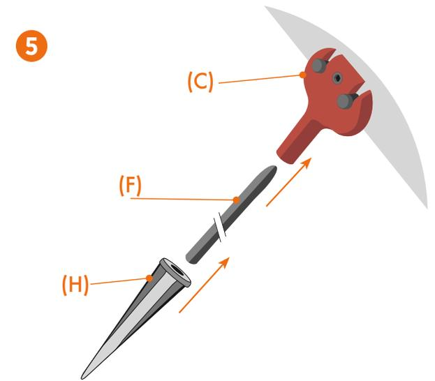
Introduisez la grande tige (F) avec l'extrémité protégée par le bouchon dans le tube de la pièce socle (C) afin de faciliter la rotation de la girouette.
