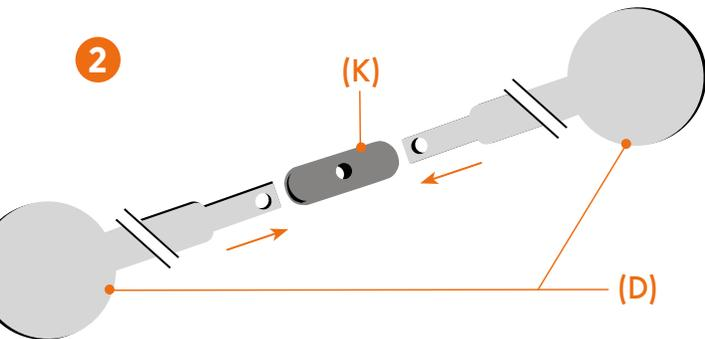
Saisissez-vous des pales (D) et pièces de jonction (K). Insérez les languettes des pales au fond des fentes des pièces de jonction.
