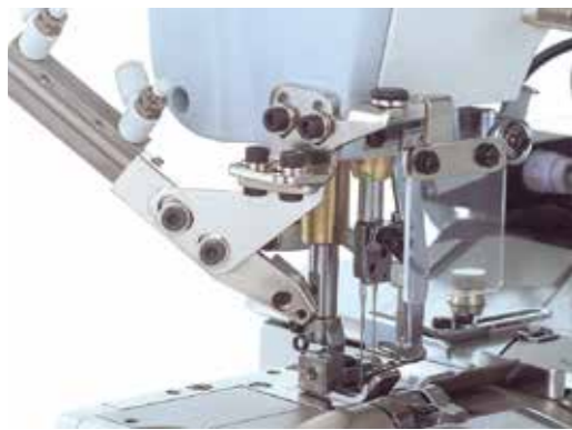
Top cover thread trimmer and underbed thread trimmer 上下线剪切装置 上下糸切り装置
