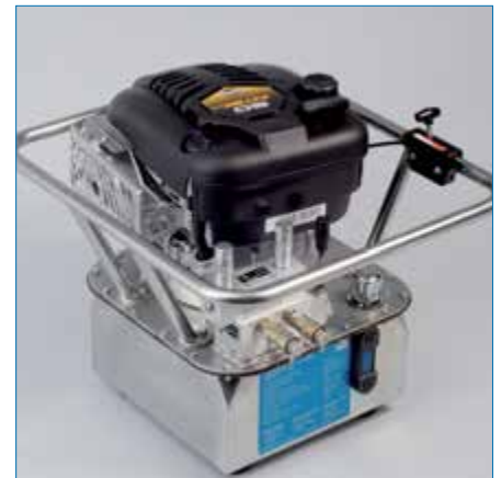
Unabhängige Hydraulikgruppe HB mit Benzinmotor Groupe hydraulique HB indépendant avec moteur à essence Independent hydraulic group HB with petrol engine
