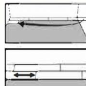
**Étape 6** - La distance minimale entre les extrémités étroites des planches en rangées parallèles ne doit pas être inférieure à 16".
