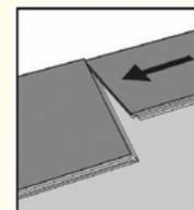
**Étape 3** - Pendant la descente, assurez-vous que les planches sont serrées les unes contre les autres. Appuyez ou tapez sur l'extrémité étroite qui vient d'être installée. Utilisez un maillet en caoutchouc si nécessaire pour assurer un verrouillage engagé sur le côté court.
