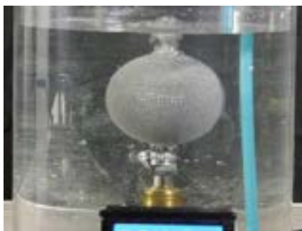
Configurazione del test per misurare l'impermeabilità all'aria
