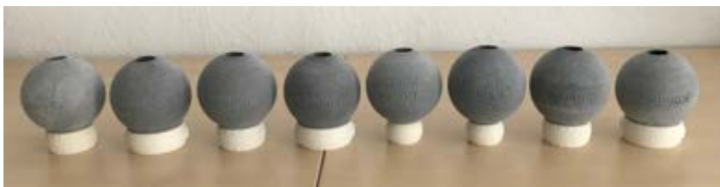
Condizioni di test per l'impermeabilità all'acqua con sfere cave
