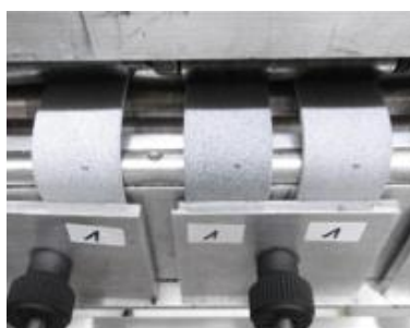
Configurazione del test di flessione Ross di Ultrasint® TPU01
