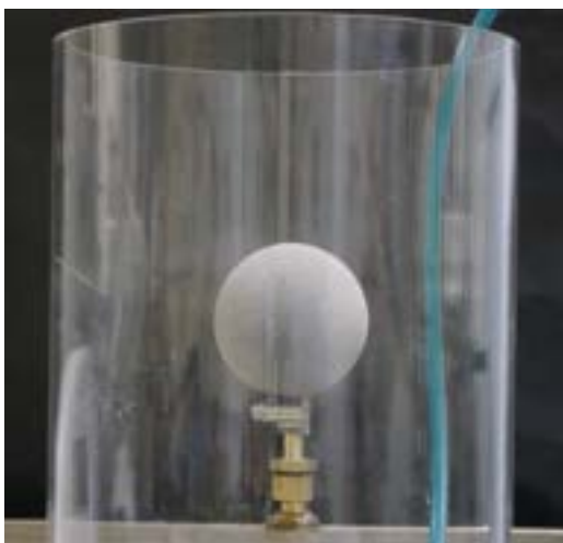
Configurazione del test per misurare la pressione di rottura
