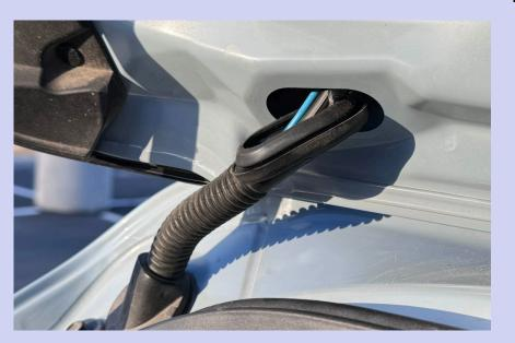
3) PULL BACK THE FACTORY HARNESS BOOT FROM BOTH ENDS AND FEED THE HARNESS THROUGH.
