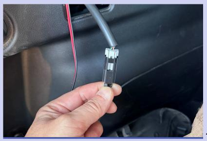
1) REMOVE FACTORY HATCH LIGHT AND PLUG IN THE CONNECTOR TO THE BLACK END OF THE INCLUDED HARNESS.
