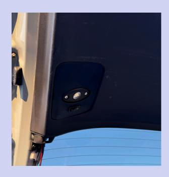
6) PLUG IN THE HARNESS INTO THE LIGHT HOUSING AND TEST BEFORE REASSEMBLING THE HATCH PANELS.
