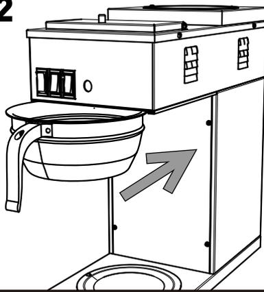
Colocar el portafiltro en la máquina por las guías, **hasta que haga tope**.
