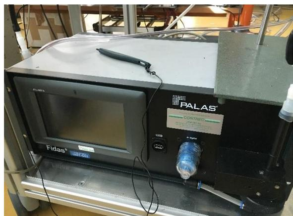
Abbildung 7: Fidas Feinstaubmessgerät
