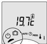
Este modo permite desactivar el sistema de calefacción. Posicione el selector en ⏻.
