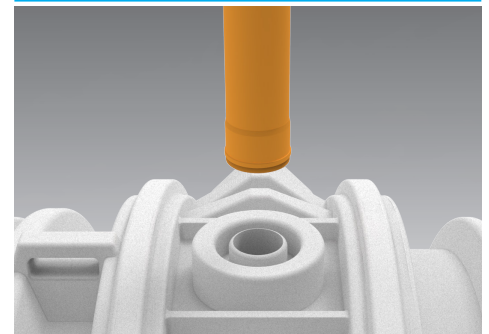
Ø110 rør med tilsluttet muffe
