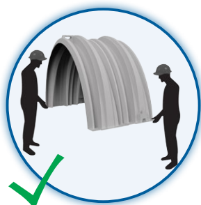
Tilskårede moduler kan håndteres af to personer
