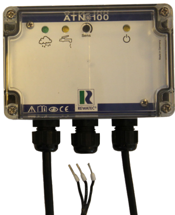
Rewatec-box med frånkopplade ledningar
