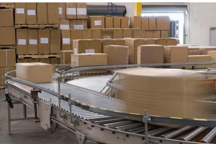
Las bandas transportadoras son equipos duraderos y confiables que se utilizan en la distribución y en procesos de almacenamiento automatizados, así como en operaciones de fabricación de productos. En combinación con equipos de manejo automatizado de tarimas, estos sistemas permiten que operaciones minoristas, mayoristas, de fabricación y de distribución sean mucho más eficientes en sus costos y tiempos de trabajo.
