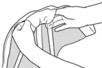
Introduzca las manos por debajo de la solapa de la bisagra superior para desconectar los broches. Repita el procedimiento con las bisagras restantes.
