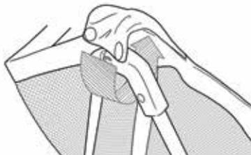
Envuelva la solapa de la cubierta de la bisagra por encima, luego por debajo de la bisagra y abróchela en el interior de la bisagra. Repita el procedimiento con las bisagras restantes.
