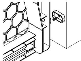
Vuelva a instalar la reja en la entrada o hueco de la puerta de acuerdo con las instrucciones y utilizando las recién instaladas almohadillas de pared como puntos de anclaje para las cuatro (4) protector de goma.
