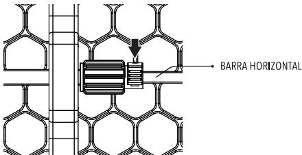
Cuando no pueda empujar más el dispositivo de ajuste, empuje hacia abajo el pasador de bloqueo. El pasador se insertará en uno de los orificios de la barra horizontal y fijará el dispositivo de ajuste en su sitio.
