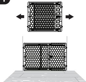
Coloque la barrera extensible en una abertura no menor de 28 pulgadas (71 cm) ni superior a 42 pulgadas (107 cm) de ancho.
