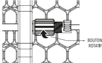
Utiliser le bouton rotatif pour serrer et fixer la barrière en position. Tourner le bouton dans le sens horaire jusqu'à ce que la pression soit suffisante pour stabiliser et sécuriser la barrière.
