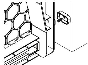
Remontez votre barrière dans l'embrasure de la porte ou dans l'ouverture en suivant les instructions; utilisez les coupelles murales nouvellement installées comme points d'ancrage des quatre (4) barrières en caoutchouc.
