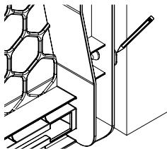
Une fois la barrière montée et lorsque vous êtes satisfait de son positionnement, tracez le contour sur la surface de l'encadrement de votre porte ou l'ouverture entourant le périmètre des (4) barrières en caoutchouc. Ensuite, retirez complètement la barrière de l'ouverture en desserrant le bouton tournant et en tirant la goupille de verrouillage vers le haut pour relâcher la pression de la barrière.
