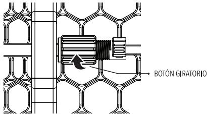
Utilice el botón giratorio para ajustar y fijar la barrera de seguridad en su sitio. Gire el botón en dirección opuesta a donde esté usted (en el sentido de las agujas del reloj) hasta crear la suficiente presión para estabilizar y fijar la barrera de seguridad.
