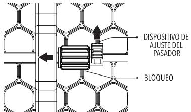
Para bloquear la barrera de seguridad en su posición, tire hacia arriba del pasador de bloqueo y deslice el dispositivo de ajuste hacia el centro de la barrera.
