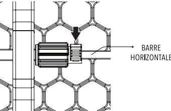
Lorsque le dispositif de réglage ne peut plus aller plus loin, abaisser la goupille de verrouillage. La goupille va s'insérer dans l'un des orifices de la barre horizontale et verrouillera le dispositif de réglage.
