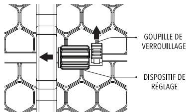
Pour verrouiller la barrière en position, pousser la groupille de verrouillage vers le haut et faire glisser le dispositif de réglage vers le centre de la barrière.
