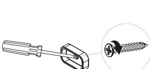
Una vez que haya retirado la puerta por completo, utilice los contornos marcados en el Paso 1 como guías para atornillar las (4) ventosas de pared. Centre cada una de las ventosas de pared dentro de los contornos de guía y utilice los tornillos autorroscantes proporcionados para sujetarlas en su lugar a través del orificio en el centro de cada ventosa de pared.
