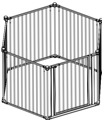
**REMARQUE :** Lors de l'ajout ou du retrait de panneaux supplémentaires, ceux-ci doivent être utilisés par paire pour assurer le bon fonctionnement de la structure autoportante.
