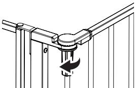
Despliegue el marco de la reja girando la perilla de la bisagra en sentido antihorario en cada junta pivotante. Esto permite que se despliega la puerta.
