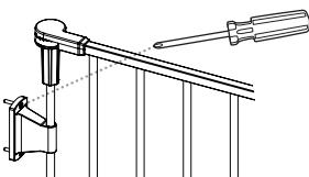
Utilisez un tournevis cruciforme/Phillips pour fixer le support de montage mural au mur. Répétez pour les quatre supports.
