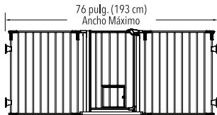
Acomode los paneles en la configuración deseada y luego apriete todas las perillas de la bisagra.
