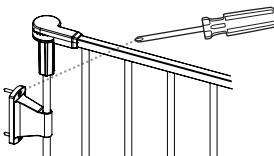
Utilice un destornillador Phillips/de estrella para fijar el soporte de montaje a la pared. Repita para los cuatro soportes.
