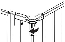
Dépliez le cadre de la barrière en desserrant les boutons de charnière de chaque articulation dans le sens contraire aux aiguilles d'une montre. Cette opération permet de plier barrière.
