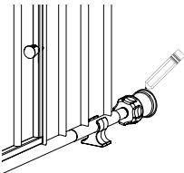
Après le montage de la barrière en position satisfaisante, tracez un cercle sur la surface de l'embrasure de la porte ou dans l'ouverture autour du périmètre des quatre (4) pieds caoutchoutés. Retirez ensuite la barrière de l'ouverture en desserrant les quatre (4) tiges filetées pour libérer la barrière.
