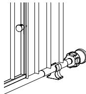
Remontez votre barrière dans l'embrasure de la porte ou dans l'ouverture en suivant les instructions; utilisez les coupelles murales nouvellement installées comme points d'ancrage des quatre (4) tiges filetées.
