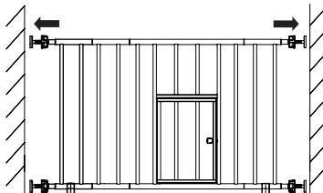
Placez la barrière de niveau et centrée dans l'embrasure de la porte ou dans l'ouverture. Tournez les molettes des tiges filetées dans la direction opposée de l'étape 2, en augmentant la distance entre le pied caoutchouté et la molette. Étendez les quatre (4) tiges filetées jusqu'à ce que le pied touche l'embrasure de la porte ou l'ouverture. Ne serrez pas complètement les tiges filetées à ce stade.
