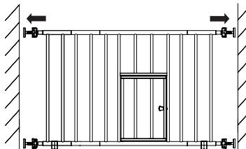
Coloque la reja de forma que quede bien nivelada y centrada en la entrada o hueco de la puerta. Gire las ruedas de ajuste en las varillas rosadas en la dirección contraria a la que se indica en el Paso 2, para ampliar el espacio entre la pata de goma y la rueda de ajuste. Extienda cada una de las cuatro (4) varillas rosadas hasta que entren en contacto con la entrada o hueco de la puerta. Todavía no apriete por completo las varillas rosadas.
