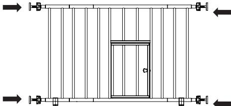
Introduzca las cuatro (4) varillas roscadas en los orificios de cada una de las cuatro esquinas de la rejilla.
