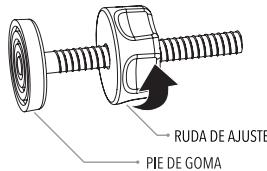
Ubique las cuatro (4) varillas roscadas (E). Gire las ruedas de ajuste a lo largo del roscado, a fin de eliminar el espacio entre la rueda de ajuste y la pata de goma.
