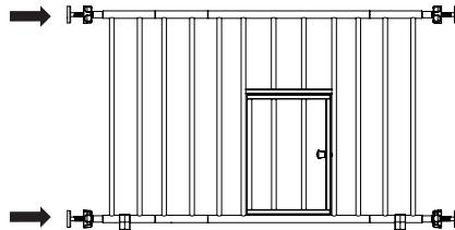
Insérez les quatre (4) tiges filetées dans les trous situés aux quatre coins de la barrière.
