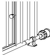
Remontez votre barrière dans l'embrasure de la porte ou dans l'ouverture en suivant les instructions; utilisez les coupelles murales nouvellement installées comme points d'ancre des quatre (4) tiges filetées.
