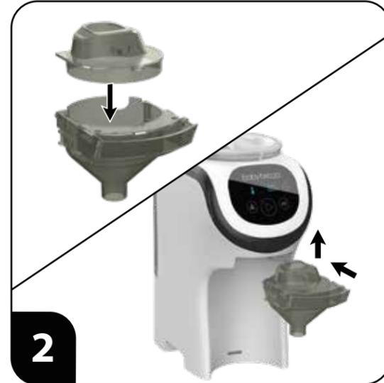
2 Bringen Sie den Trichter **und die Trichterabdeckung** an. Setzen Sie anschließend die Trichtereinheit in das Trichterfach ein, indem Sie diese zunächst nach oben und anschließend nach innen schieben.
