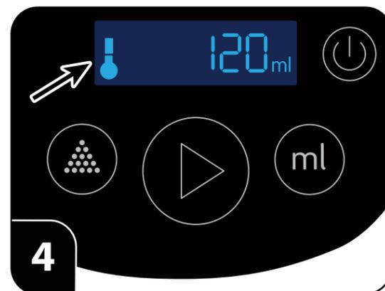
**Die Temperaturanzeige blinkt beim Aufheizen und leuchtet durchgehend, wenn die eingestellte Temperatur erreicht wurde.**
