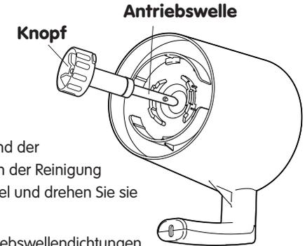
\*Stellen Sie immer sicher, dass die Antriebswelle und die Antriebswellendichtungen richtig eingesetzt und verriegelt sind, um Schäden am Behälter und der Basis zu vermeiden.
