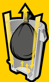
CANALES DE VENTILACIÓN INTEGRADOS
