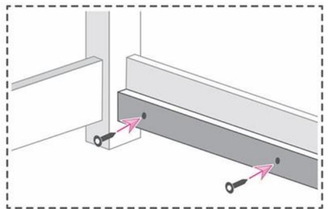
*Fixer les montants de maintien de sommier en alignant le bas avec le bas de la structure de lit ou en réglant la hauteur pour s'adapter à l'épaisseur de votre matelas.*
