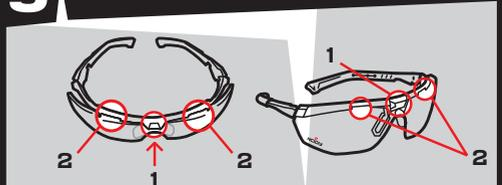
Vergewissern Sie sich vor der Nutzung der Brille, dass die Gläser ordnungsgemäß in den Rahmen eingesetzt sind. Beginnen Sie dazu am mittleren Punkt der Nase und befestigen Sie dann den rechten und linken Clip.
