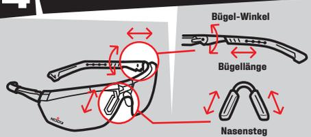
Die Brille bietet zahlreiche Einstellmöglichkeiten, um einen sicheren, bequemen Sitz zu gewährleisten. Durch Einstellen des Bügelwinkels lässt sich auch der Lufteinlass steuern.
