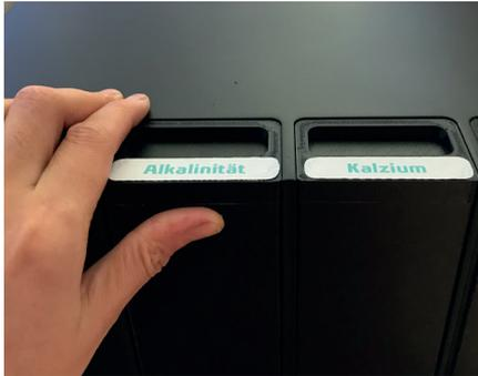
**3.** Nun kannst Du die neue Kartusche in Deinen Korallenwächter einsetzen. Schiebe sie dazu vollständig hinein, bis sie klickt und die Status LED Dir durch ein weißes Blinken signalisiert, dass die Kartusche korrekt installiert wurde.
