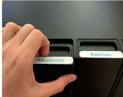
**1.** Entferne die verbrauchte Kartusche aus dem Korallenwächter, indem Du sie nach vorn herausziehst. Entferne die Verschlussstopfen der neuen Kartusche und verschließe damit die verbrauchte.
