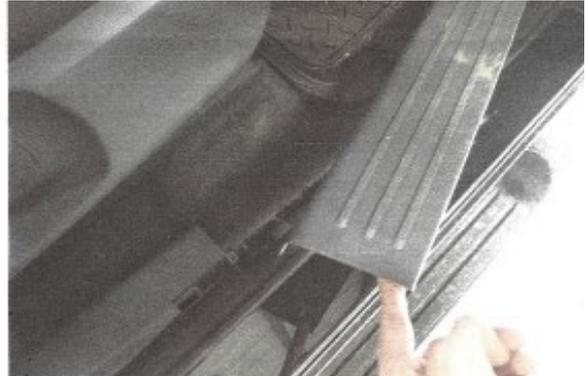
Entfernen Sie die Kunststoffabdeckung des Schwellers (wie abgebildet).
