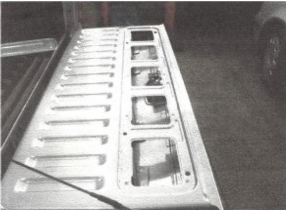
Öffnen Sie die Heckklappe und drehen Sie die Schrauben aus der Kunststoff-Laderaumabdeckung heraus (diese könnten verklebt sein). Öffnen Sie die Wartungsklappe.
