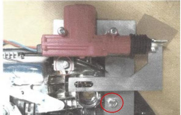
Befestigen Sie den Stellmotor mit den zwei Schrauben, die Sie in Schritt 2 entfernt haben
