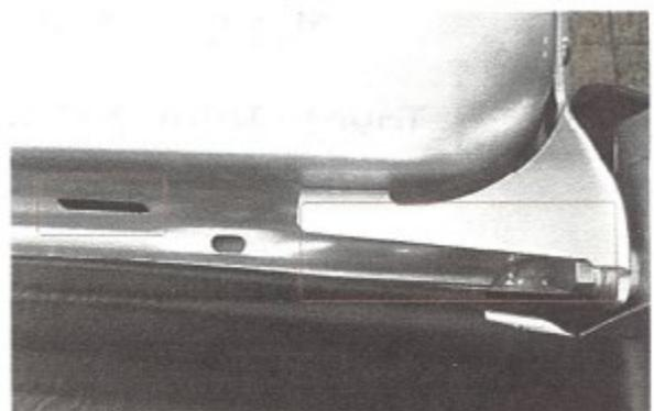
Führen Sie das Kabel am Rahmen entlang bis vor unter die Fahrer- bzw. Beifahrertürschwelle
