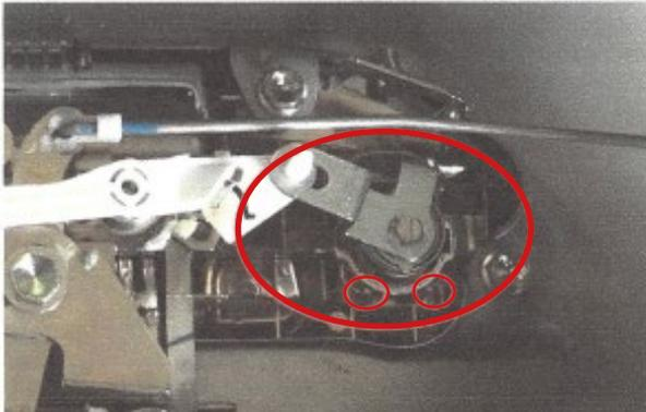
Entfernen Sie den Schlossschlüssel (Federclip zusammendrücken und herausziehen)
