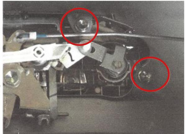
Entfernen Sie die beiden Schrauben von dem Griff der Heckklappe (hier wird der Stellmotor – siehe Abb. 4 – montiert).
