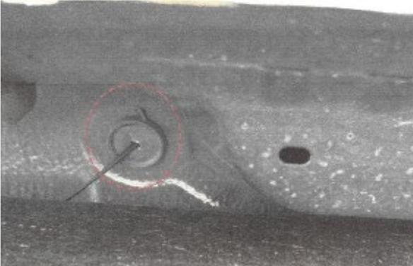
Führen Sie das Kabel am Fahrzeugrahmen entlang bis unter den Fahrersitz. Dort befindet sich ein Gummistöpsel auf Höhe des Türschwellers.
