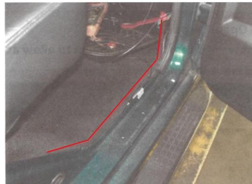
Führen Sie das Kabel unten aus der linken Heckklappe heraus (Scheuerschutztüle nicht vergessen). Führen Sie das Kabel am Fahrzeugrahmen entlang bis unter den Fahrersitz. Entfernen Sie die Kunststoffabdeckung des Schwellers. Führen Sie das Kabel in das Fahrzeuginnere und demontieren Sie die Plastikabdeckung auf der linken Seite.
