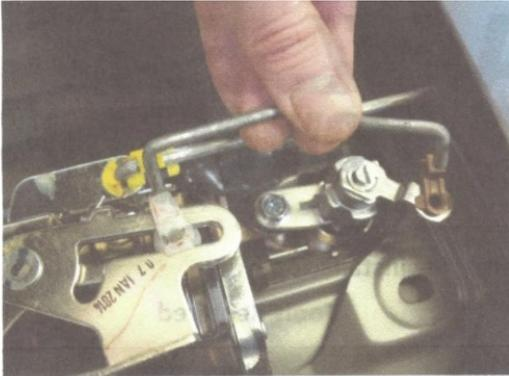
Entfernen Sie das original **Schloss-Gestänge** aus dem Fahrzeug.
