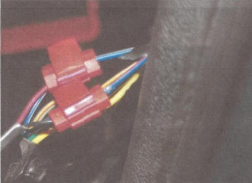
Löten Sie den Kabelbaum an die Fahrzeugelektrik an. Bitte beachten Sie, dass jede Verbindung angemessen und sicher mit geeignetem Isoliermaterial abgedeckt werden muss.
