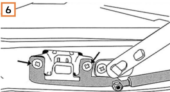
6 Befestigen Sie den Dämpfer mit den original Schrauben nun auch an der Heckklappe.
