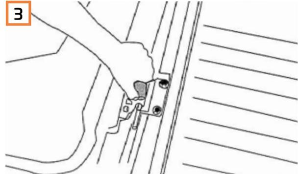
3 Öffnen Sie die Heckklappe komplett und entnehmen Sie die Gummistopper.
