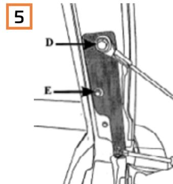
5 Befestigen Sie den Dämpfer mit dem Untergerüst am Fahrzeug mit Hilfe einer M6 Schraube und Mutter siehe Abbildung D & E. Bauen Sie anschließend die Schlussleuchte wieder ein.
