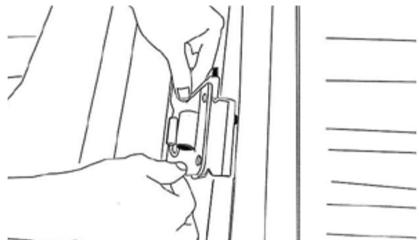
Entfernen Sie das original Heckklappen-Scharnier und ersetzen Sie es mit den ProLift Scharnieren. Verwenden Sie hierzu die original Schrauben.
