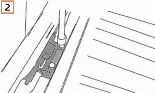
2 Heben Sie die Heckklappe in die benötigte Position an und befestigen Sie die beiden Schrauben.
