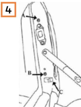
4 Lösen Sie die Schrauben A und B um die Schlussleuchte zu entfernen sowie den Gummistopper C. **ACHTUNG:** Bitte entnehmen Sie die Schlussleuchte vorsichtig in die korrekte Richtung, nach hinten!
