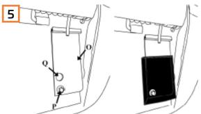
Befestigen Sie den Federdruckbügel (Ö) mit der Original-Halterung (P). Wenn der Pickup einen Stoppgummi hat, kann er durch das Loch
