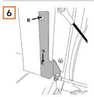
Dämpfer mit Originalhalterung am Pickup befestigen (R) (S)
