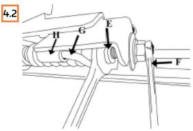
Ziehen Sie die Mutter (E) an, während Sie die Stange des Federsatzes mit dem Schlüssel Nr. 7 (F) festhalten.
