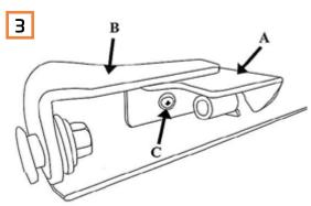
Befestigen Sie die Heckklappenhalterung (A) an der Heckklappenhalterung (B) mit der Originalschraube (C)
