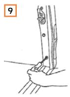
Tauschen Sie die Schrauben der Rückleuchten gegen Rundkopfschrauben aus (im Lieferumfang enthalten)
