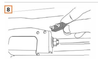
Stoppergummi mit Heckklappenhalterung einsetzen
