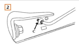
Lösen Sie die abgebildete Schraube (C) Hinweis: Bitte berücksichtigen Sie die Kabel des Parksensors.
