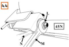
Ziehen Sie die Mutter (L) mit dem Schlüssel #14 (M) an, während Sie die Mutter (E) mit dem Schlüssel #14 (N) festhalten.
