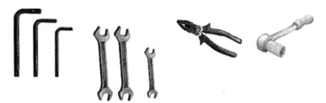
Imbusschlüssel, Schraubenschlüssel Nr. 7 und 14, Zange, Nuss Nr. 13, 19, 21, T-Schlüssel Nr. 8, 10
