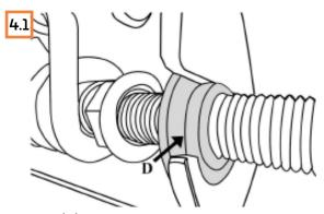
Flansch (D), wie abgebildet in die Bohrung der Heckklappenhalterung stecken.
