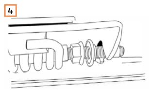
Setzen Sie den Federsatz mit Heckklappenhalterung wie abgebildet ein.
