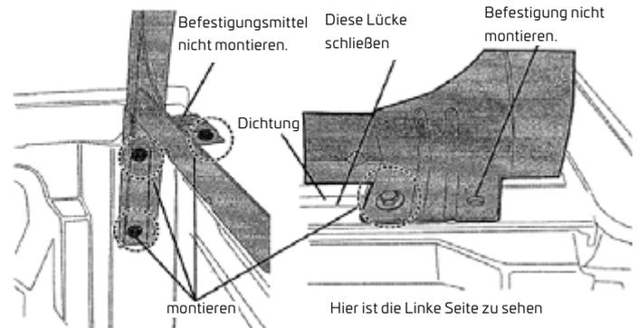
Bringen Sie das Gitter wieder an der Wanne an (Achten Sie darauf, dass die vorderen Spalten zwischen dem vorderen Wannenbrett und dem Kabinenschutz beseitigt werden)
