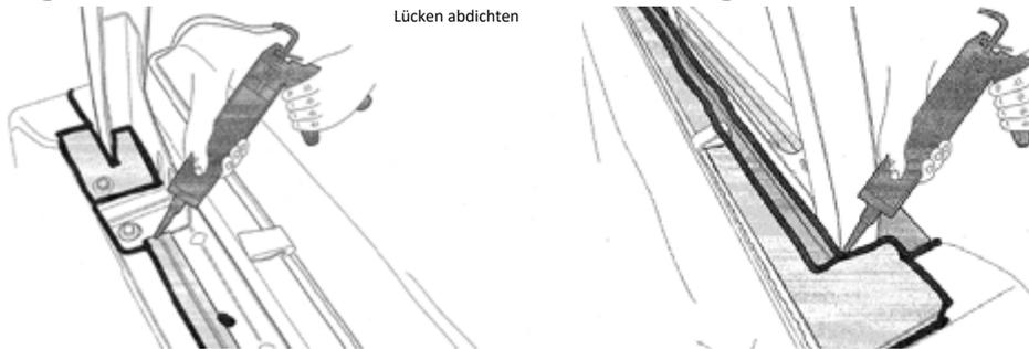
Dichten Sie alle Lücken in und um den Kabinenschutz mit Silikon (nicht mitgeliefert) ab. Lassen Sie das Silikon-gel vor jeder Aktivität trocknen. Dieser Schritt ist wichtig, da er das Durchsickern in den Schalenkörper unter feuchten Bedingungen minimiert.
