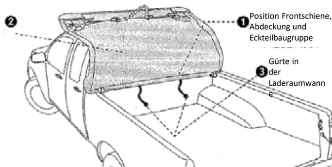
Positionieren Sie die vordere Schiene an der Vorderseite der Wanne. Legen Sie die Abdeckung vorsichtig über die Fahrzeugkabine. Stellen Sie sicher, dass die Gurte in der Wanne sind.
