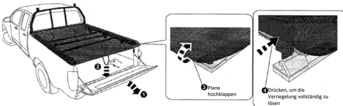
Öffnen Sie die Heckklappe. Platzieren Sie die Entriegelungslasche unter der hinteren Mitte der Abdeckung und ziehen Sie nach unten, um die Verriegelungen zu lösen. Klappen Sie die hintere Kante nach oben, um die Verriegelungen vollständig zu lösen.
