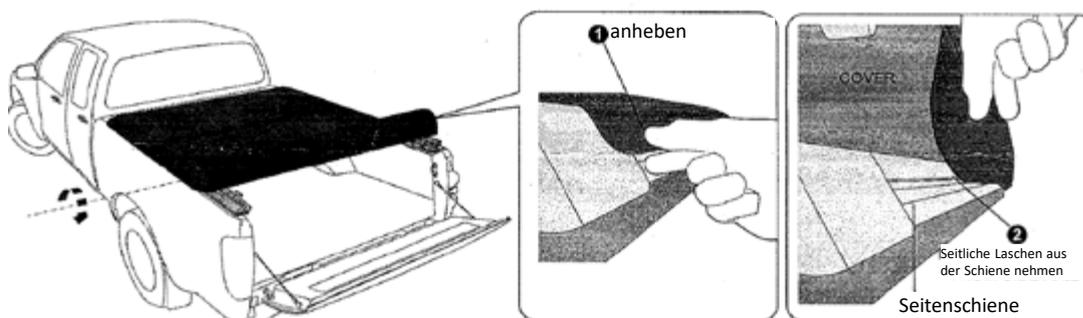
Greifen und heben Sie von hinten nach vorne die Seiten der Abdeckung nach oben, um die flexiblen Laschen von den Seitenschiene zu lösen. **Wichtig: Stellen Sie sicher, dass die Laschen vor dem Aufrollen der Plane gelöst werden, da sie sonst beschädigt werden können.**
