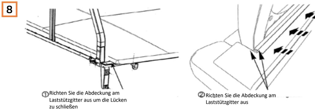
Richten Sie die Plane an den Beinen des Laststützgitters aus, um die Lücken zu schließen.
