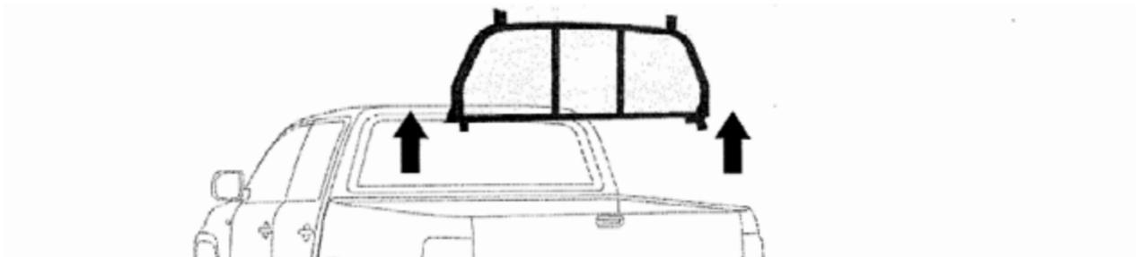
Entfernen Sie das Laststützgitter von der Ladefläche
