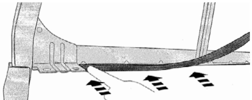
Bringen Sie die Kabinenschutzdichtung im vorderen Bereich des Laststützgitters an
