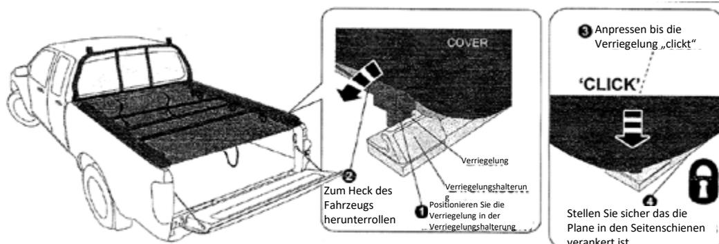
Rollen Sie die Abdeckung über die Wanne in Richtung Fahrzeugheck. Befestigen Sie die Abdeckung an den Längsträgern, indem Sie die flexiblen Flügel der Abdeckung nach außen klappen und unter den Rand der Längsträger einrollen. Zum Einrasten drücken Sie diese fest auf die Außenseite der Abdeckung.
