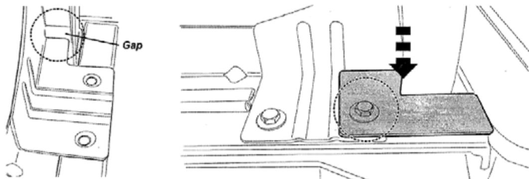
Setzen Sie die vorderen Halterungen in die entsprechenden Taschen des Kabinenschutzes. Richten Sie die Halterungen aus, um die Lücke zu schließen, und ziehen Sie sie fest.
