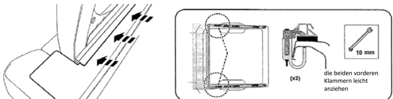
Schieben Sie die SFTC-Frontplatte / Seitenholme nach vorne gegen das Laststützgitter, um die Lücke zwischen ihnen zu schließen. Ziehen Sie die vorderen Klammern leicht an.
