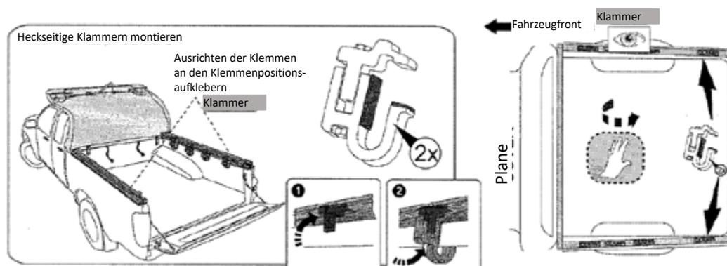
Wiederholen Sie den Vorgang und montieren Sie die hinteren Klammern an den Längsträgern und der Wanne, wobei Sie sicherstellen müssen, dass die Längsträger bündig mit der Außenseite des Wannenkörpers abschließen.
