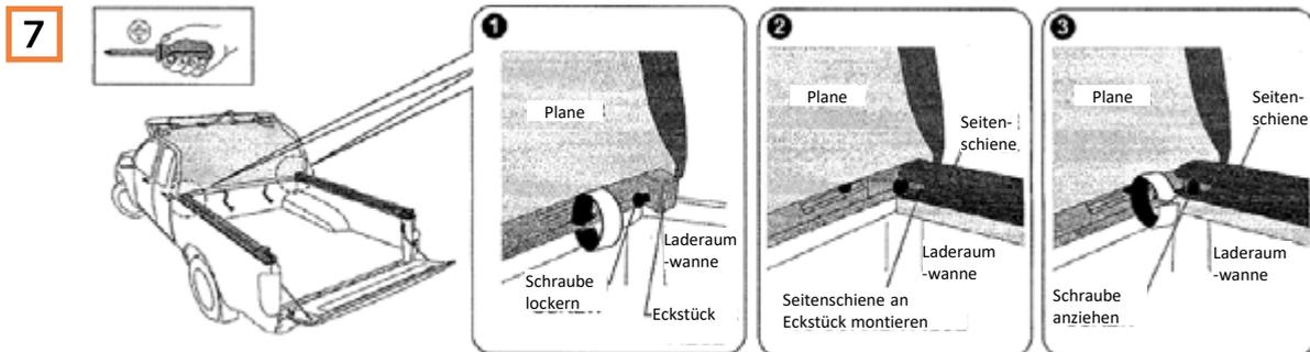
Lösen Sie die Schrauben (achten Sie darauf, dass sie sich nicht von den Sicherungsmuttern lösen) auf jeder Seite der vorderen Schienenecken. Rasten Sie die Seitenholme in die vorderen Holmecken ein und stellen Sie sicher, dass sie vollständig eingesetzt sind. Ziehen Sie die Schrauben auf beiden Seiten fest an, um die Längsträger fest an den vorderen Holm zu klemmen.
