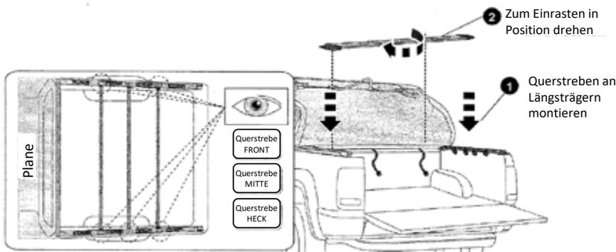
Bringen Sie den Querbalken mit der Markierung „vorne“ in der Nähe der Kabine und den Querbalken mit der Markierung „hinten“ in der Nähe der Heckklappe an. Bringen Sie die mit „Mitte“ markierte Querstange zwischen der vorderen und hinteren Querstange an.
