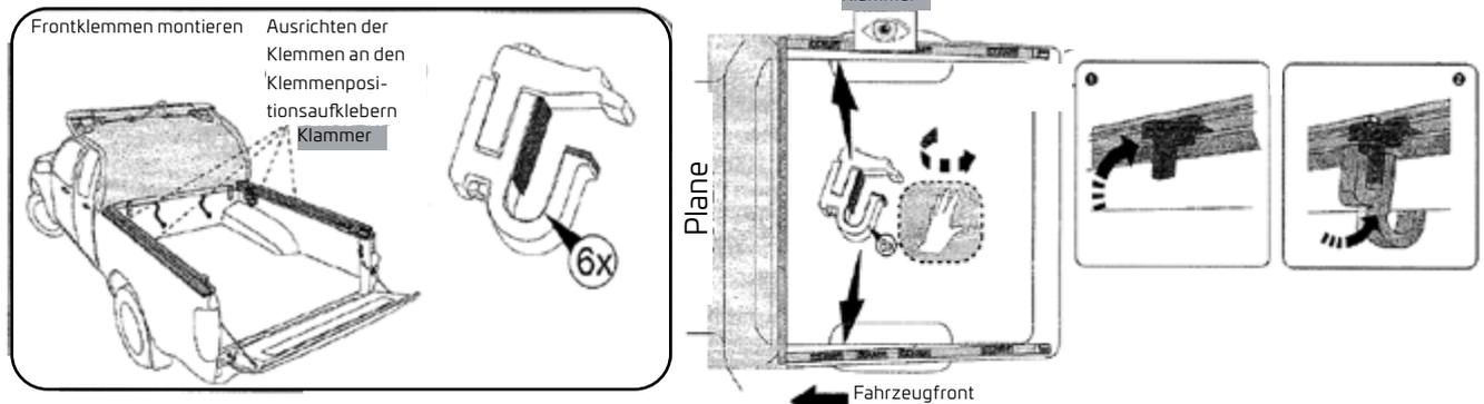
Befestigen Sie die vorderen Klammern mit den Klammernpositionsaufklebern an den Seitenschienen am Wannengehäuse und stellen Sie sicher, dass die Seitenschienen mit der Aussenseite des Wannengehäuses bündig sind.
