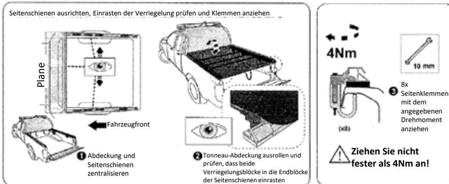
Längsträger zentralisieren und ausrichten. Überprüfen Sie die Position der Seitenholme, indem Sie die Abdeckung ausrollen und sicherstellen, dass die Seitenriegel in die Seitenholmblöcke an der Rückseite der Plane einrasten. Wenn die Abdeckung korrekt ausgerichtet ist, legen Sie sie wieder auf das Fahrzeugdach und ziehen Sie die vorderen und hinteren Seitenklammern mit dem angegebenen Drehmoment fest.
