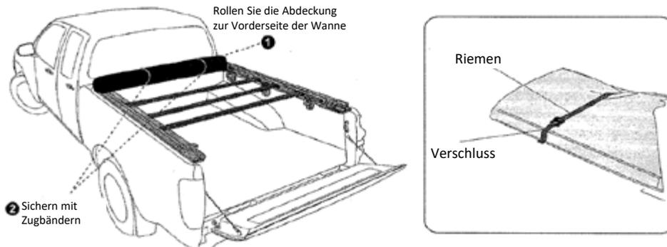
Rollen Sie die Abdeckung an die Vorderseite des Fahrzeugs und befestigen Sie sie mit den Zugbändern.
