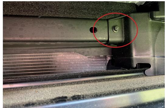
Befestigen Sie die markierten Versteifungen an Ihrem Fahrzeug mit den original Schrauben.
