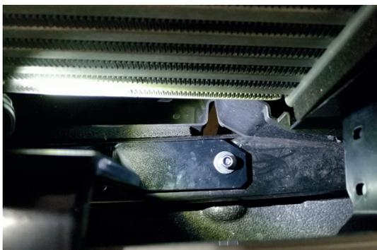
Der Scheinwerferhalter wird unten am Stoßstangenträger mit 2 mitgelieferten M8 Schrauben montiert.
