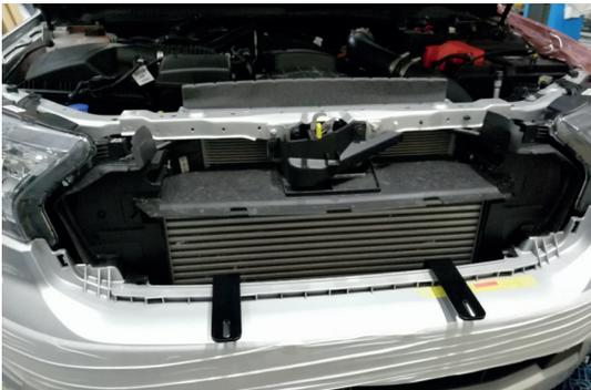
Legen Sie nun die Scheinwerferhalterung mittig an die Stoßstange und zeichnen Sie die Bohrlöcher an.
