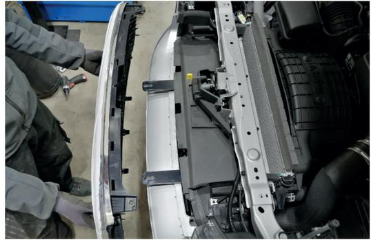
Danach demontieren Sie den Kühlergrill.
